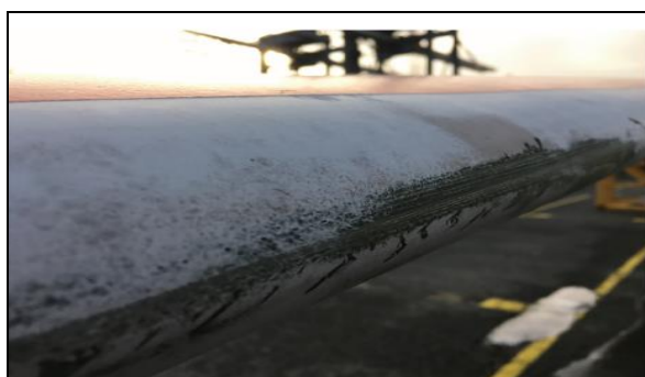
Figura 1. Ejemplo de rugosidad en el borde de ataque (LER) de una pala de aerogenerador
