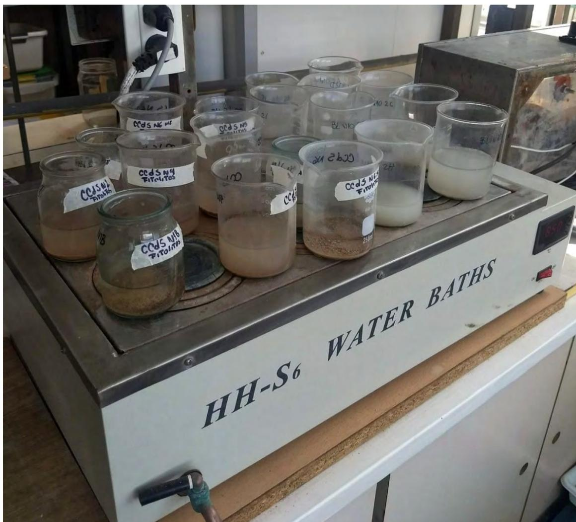
**Figura 3.17.** Eliminación de cementos en baño termostático a 70 °C.
