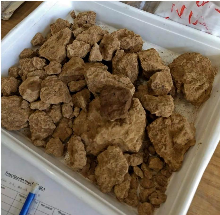
**Figura 3.16.** Reducción de muestra y cuarteado sin mortero.
