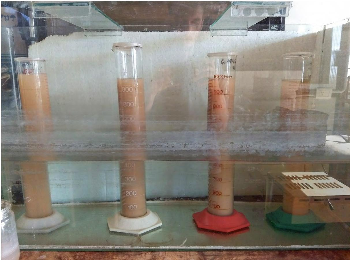
**Figura 3.14.** Probetas con limo y arcilla en suspensión en pecera a temperatura controlada para estimación de abundancias por decantación y pipeteo.
