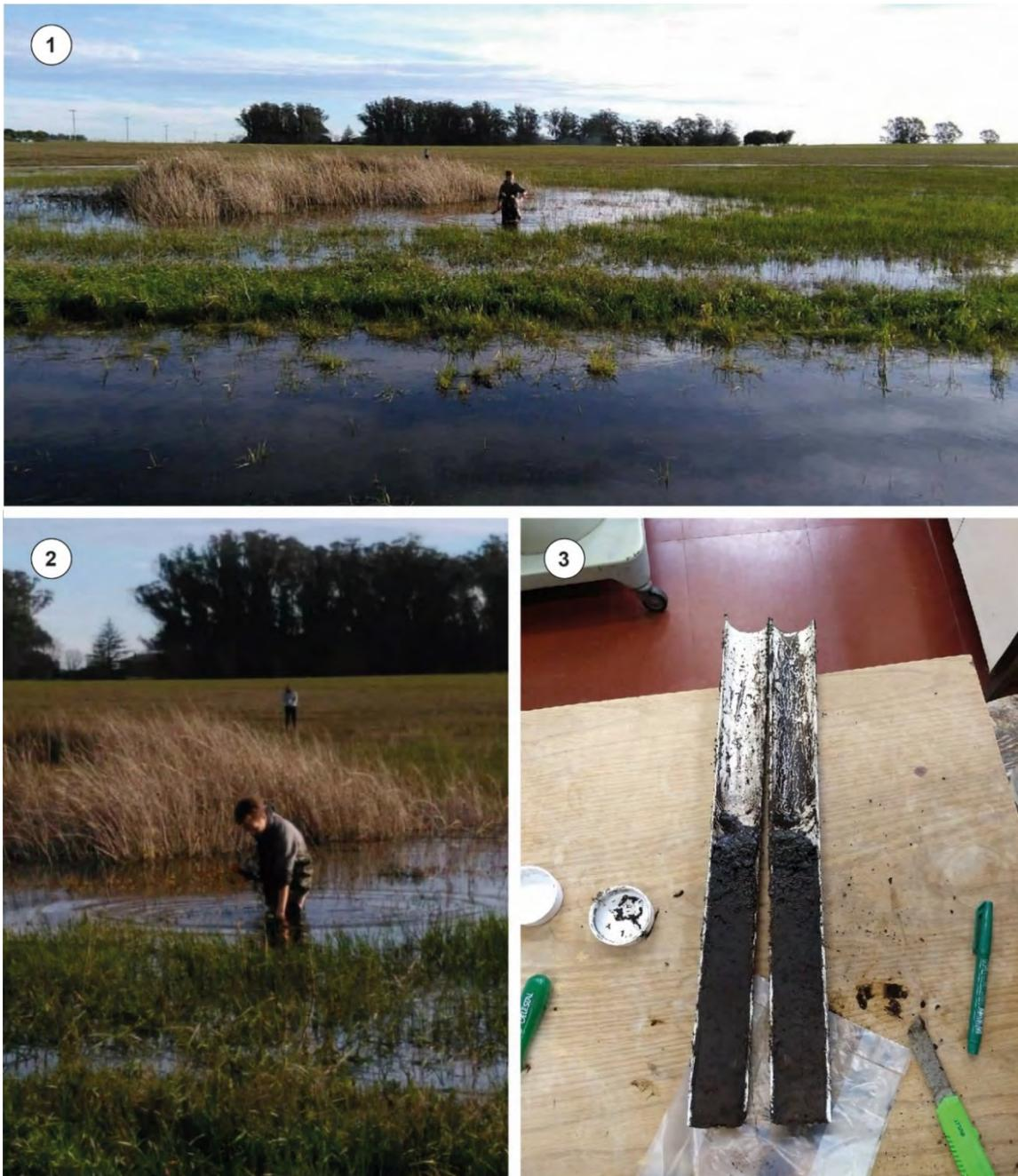
**Figura 3.6.** 1–2, Obtención de testigos en lagunas someras; 3, Apertura de testigos en gabinete.
