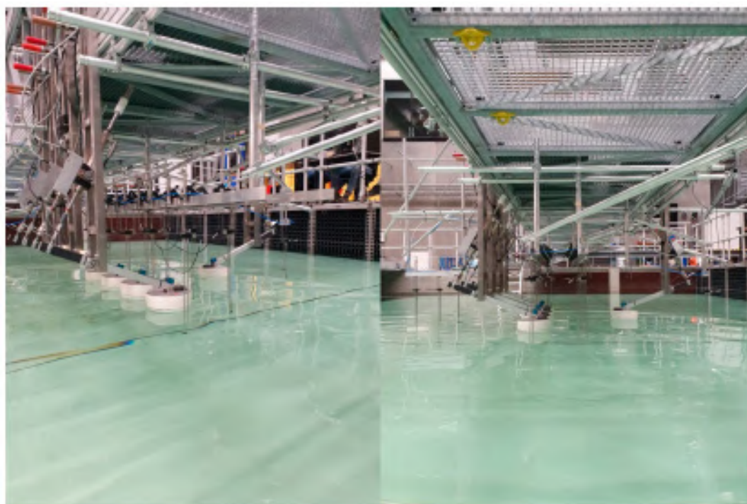
Figura 7: Una de las configuraciones posibles de arreglos de convertidores de energía de ola tipo absorbedor puntual, ensayada en el tanque de olas de la Universidad de Aalborg, Dinamarca.
