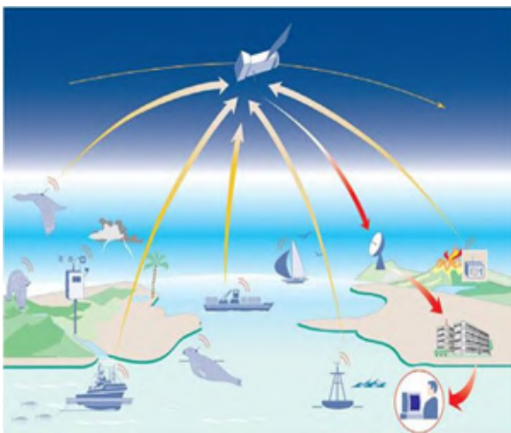
Figura 1 – Distintos componentes de los sistemas DCS satelitales (fuente: Argos, CONAE)
