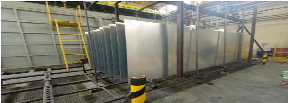
**Figura 3.** Disposición de chapas de aluminio 2219-T851 previo a recocido total.
