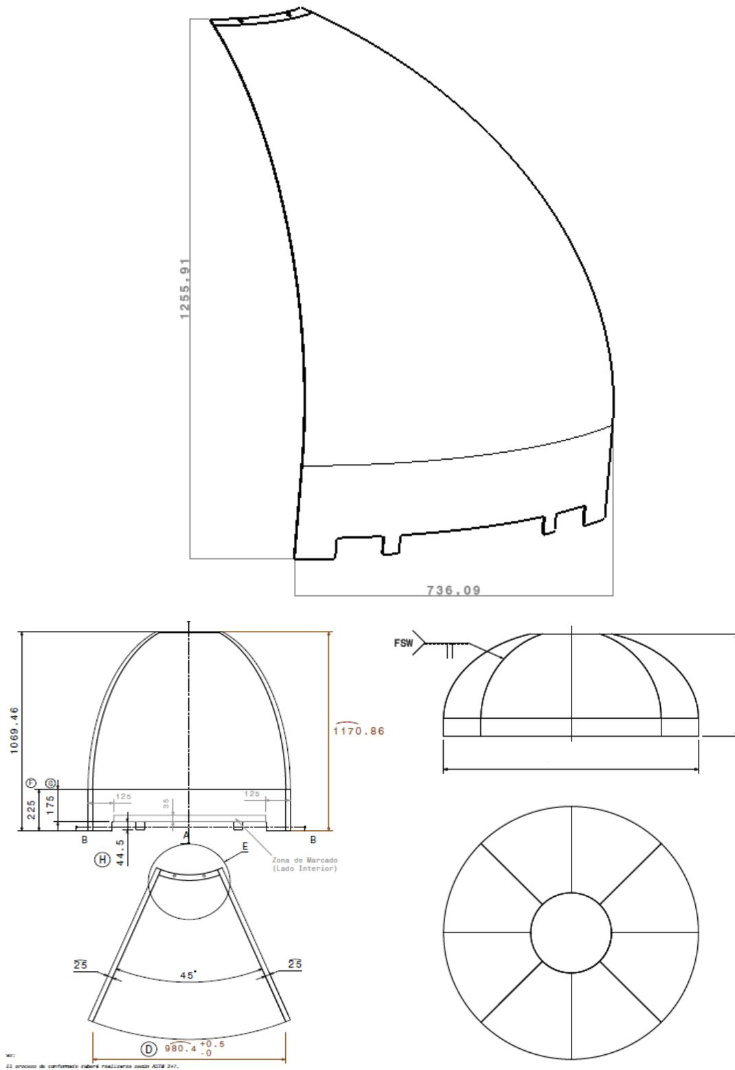
Figura 1. Planos y dimensiones de gajos conformados.
