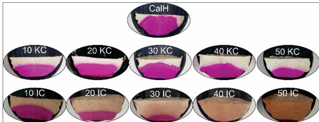
Figura 15. Perfil de carbonatación con fenolftaleína en pastas 28 días cámara húmeda + 1 mes carbonatación (ii).
