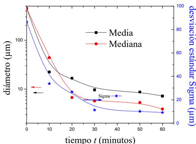
**Figura 6.** Diámetro mediano y medio, y sigma versus tiempo de molienda. Los puntos fueron extraídos de la modelación de las distribuciones granulométricas en cada tiempo experimental. Las curvas describen la tendencia.
