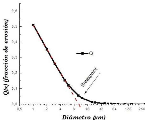
**Figura 5.** Fracción de erosión  $Q$  versus el diámetro  $x$  ( $\mu\text{m}$ ). El diámetro de breakpoint se determina en la intersección de las tangentes de los comportamientos de los tamaños grandes y pequeños.
