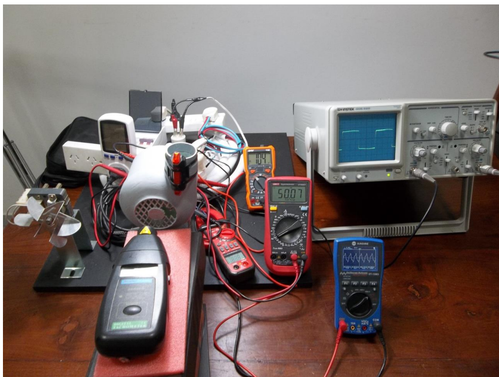
Foto del banco de pruebas conectado al motor extractor/soplador centrífugo de aire viciado de SARS-CoV-2 o Covid-19 (Coronavirus): Turbo. Con multímetro digital (medidor de voltios en
