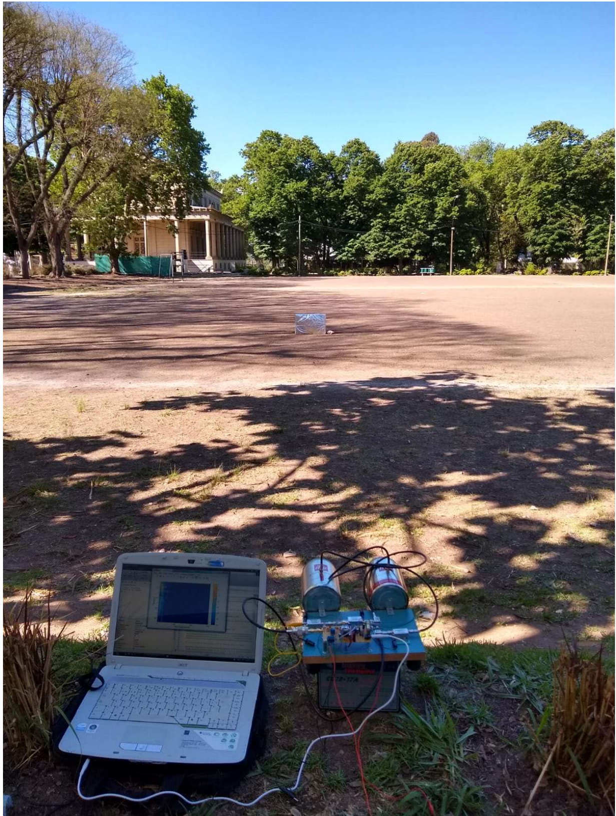
Figura 65: Radar montado para adquirir datos. Se pueden apreciar el objetivo y el escenario de medición
