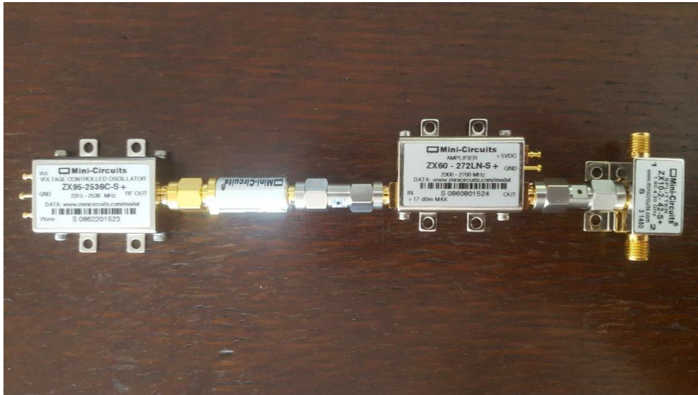
Figura 38: Etapa de transmisión montada. De izquierda a derecha se pueden ver el VCO, el atenuador pasivo, el LNA y el Splitter
