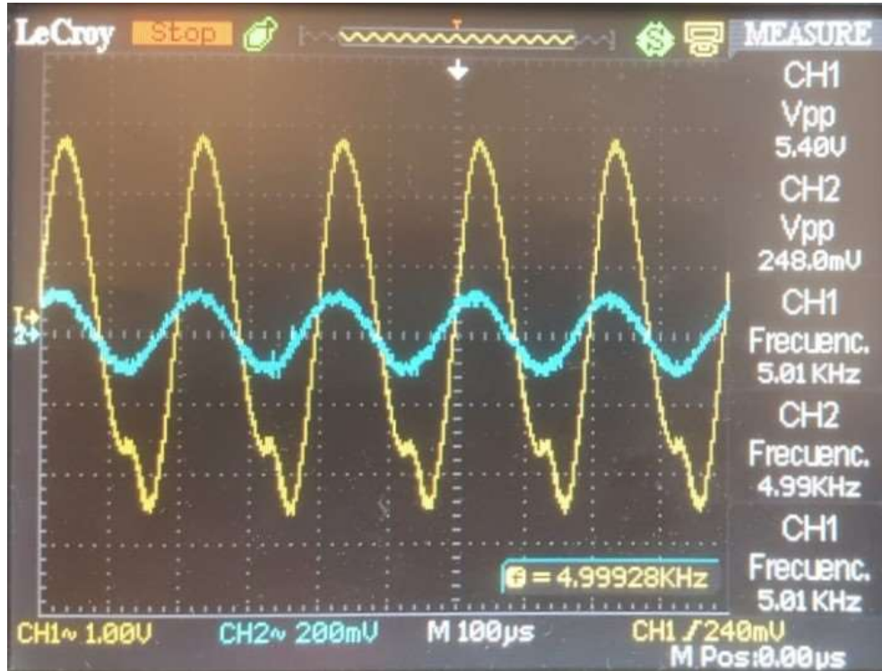
Figura 31: Señales de entrada (azul) y salida (amarillo) del filtro activo aumentando el valor de ganancia hasta producir la saturación debido a que la señal de salida supera el valor de alimentación
