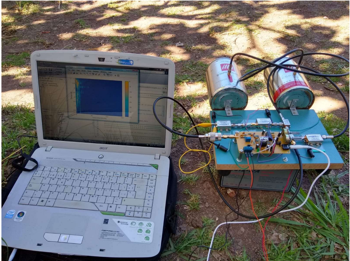
Figura 63: Radar montado listo para realizar las mediciones correspondientes en el campo de deportes.
