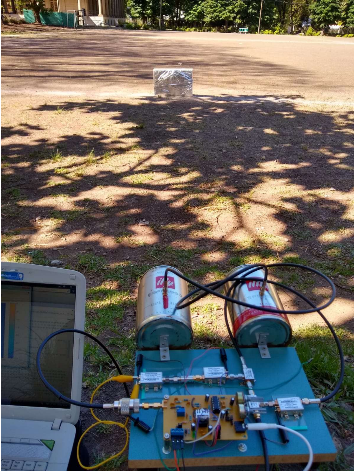
Figura 64: Radar apuntando al objetivo. El objetivo: Escudo refractante fabricado con una caja de cartón cubierta en papel aluminio.
