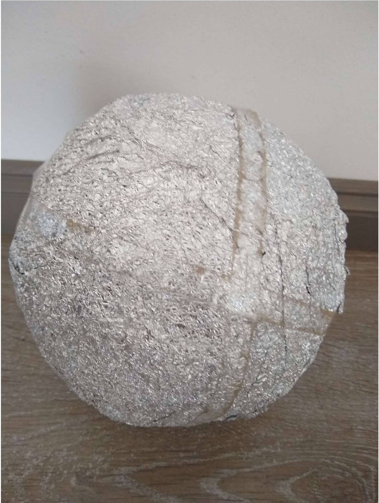
Figura 68: Pelota de goma y recubierta de aluminio, utilizada como objetivo para los distintos experimentos realizados
