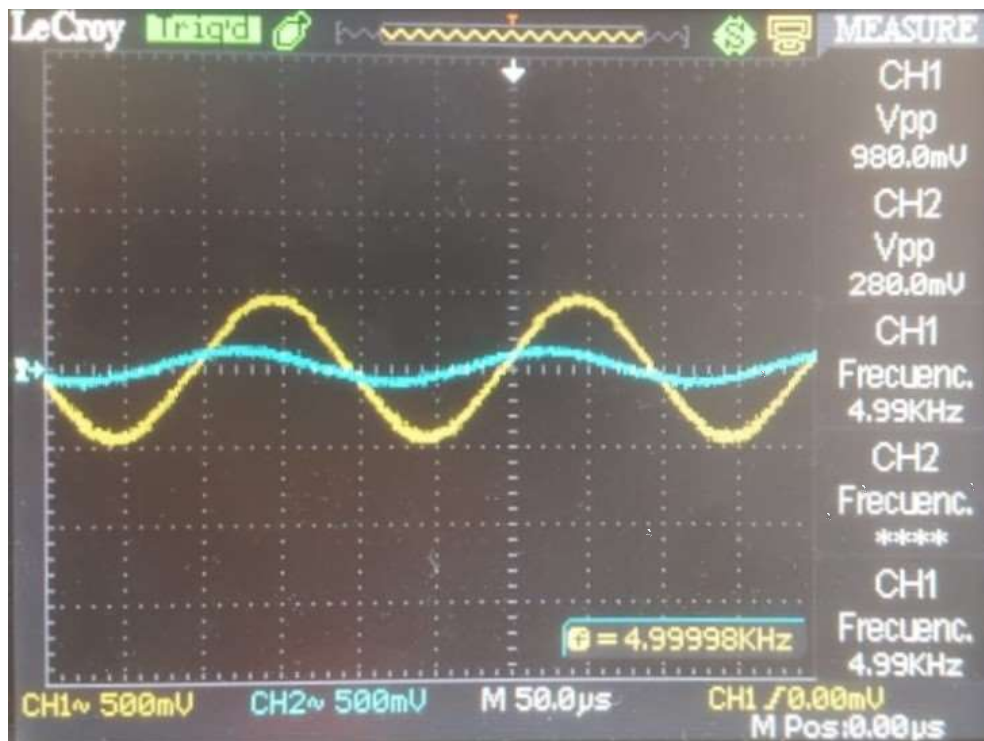
Figura 29: Señales de entrada (azul) y salida (amarillo) del filtro activo aumentando el valor de ganancia
