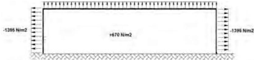
Figura 4: Presiones sobre paredes laterales
