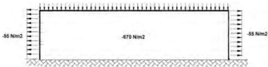
Figura 6: Presiones sobre paredes laterales
