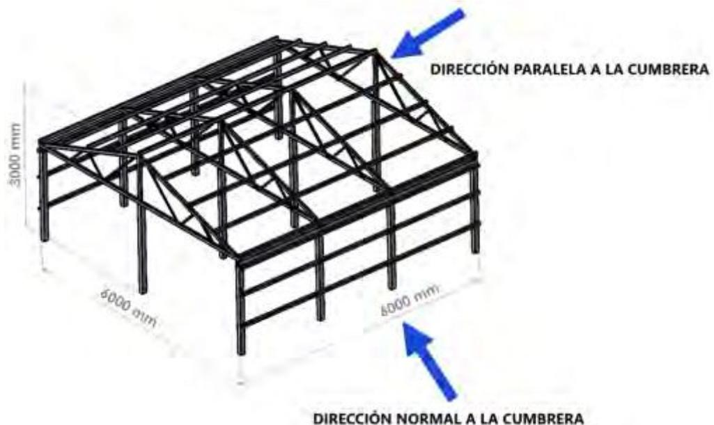
Figura 1: Dimensiones de la estructura y direcciones del viento
