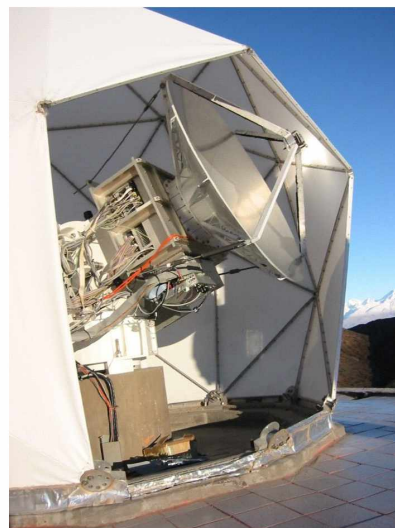
Figura 5: El SST con el radomo abierto para tareas de mantenimiento.
