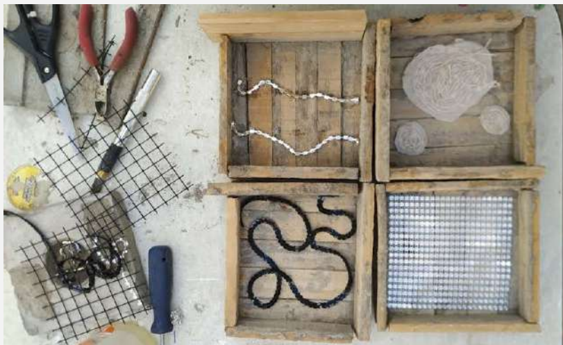
Arriba: moldes de madera , lina de strass, cemento y lanas. Abajo: moldes preparados para rellenar.
