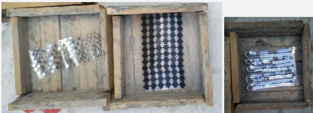
Moldes con objetos adheridos en concreto.
