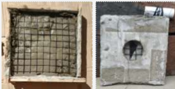
Arriba: Veteza rota se puede ver la malla que hay debajo. Izq.: molde, malla y cemento. Der.: cemento y malla en el interior. Hilos. 14 x 14 cm
