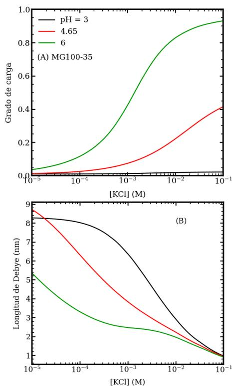
Figura 3.6: Curvas del grado de carga MAA (A) y la longitud de Debye (B) dentro de los microgeles MG100-35 en función de la concentración de sal para diferentes valores de pH. Estos resultados corresponden a las mismas condiciones de la figura 3.5B.
