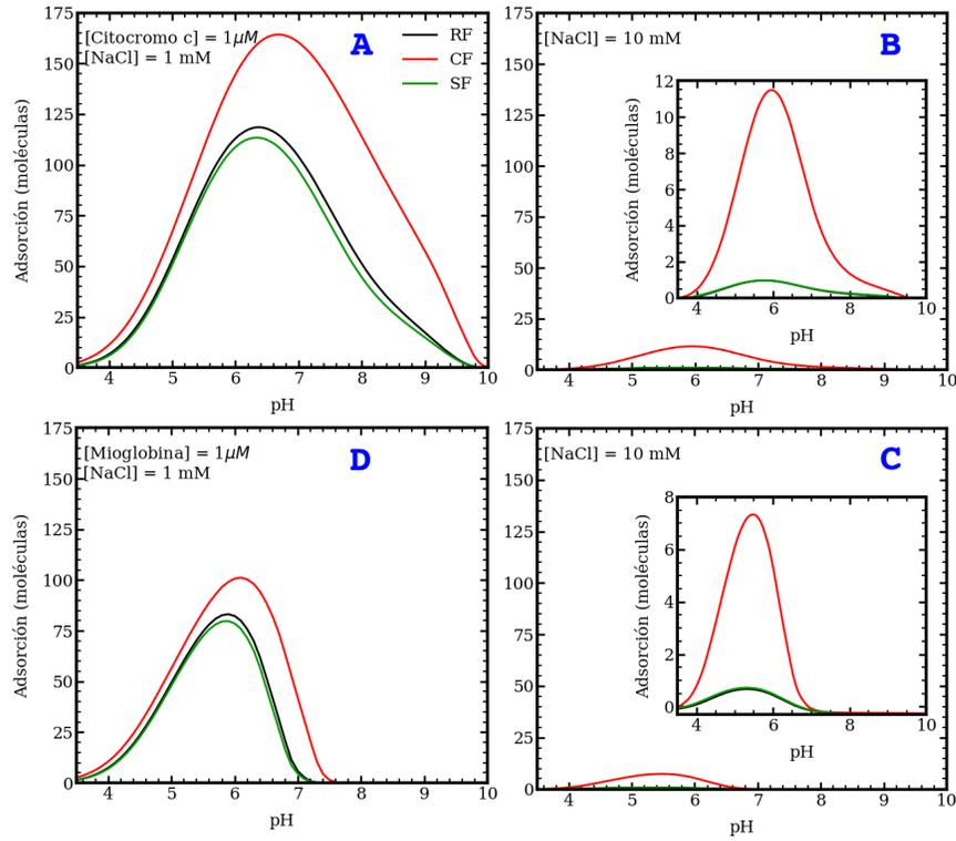
Figura 4.6: Gráficos de la adsorción en exceso  $\Gamma$  de citocromo c (paneles A y B) y mioglobina (paneles C y D) a nanogeles MAA-VA en función del pH. La concentración de sal es  $10^{-3}M$  en los paneles de la izquierda (A y C) y  $10^{-2}M$  en los paneles de la derecha (B y D); En los paneles B y C Se muestra en el inset un zoom de la adsorción. Estos nanogeles tienen 22 % MAA; la concentración de proteína es  $10^{-6}M$  en cada caso.
