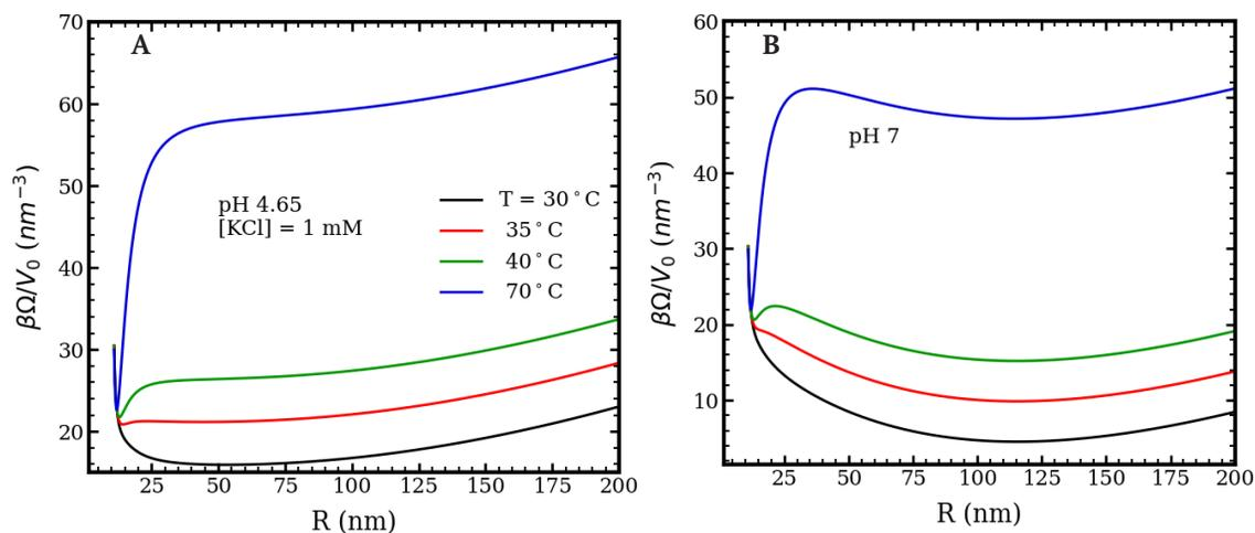
Figura 5.9: Energía libre interna de un nanogel aislado como función de su radio. Las diferentes curvas muestran el cambio de la energía al aumentar la temperatura, la concentración salina es 1 mM en KCl. Los paneles A y B corresponden a pH 4.65 y 7 respectivamente.
