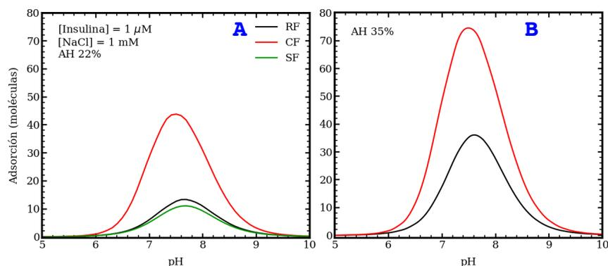
Figura 4.9: Gráficos de las moléculas de insulina adsorbidas,  $\Gamma$ , en función del pH para nanogeles AH-VA con diferentes funcionalizaciones. El contenido de AH es del 22 % para las redes poliméricas del panel A y del 35 % para las del panel B (este último grado de funcionalización no se alcanza para el nanogel SF). La concentración de sal es  $10^{-3}$  M de NaCl y  $[\text{Insulina}] = 10^{-6}$  M.
