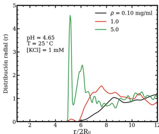
Figura 5.6: Función de distribución radial para las tres soluciones de nanogeles. Las curvas corresponden a las tres concentraciones de nanogeles consideradas: 0.10, 1.0, 5 mg/ml. Las condiciones del bulk de la solución son  $\text{pH} = 4.65$ ,  $[\text{KCl}] = 1$  mM, la temperatura del sistema es  $25^\circ\text{C}$ . En el eje x se ha usado el valor de radio seco,  $R_0 = 10$  nm, de los nanogeles para usar unidades reducidas en la distancia nanogel-nanogel.
