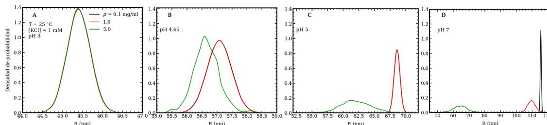
Figura 5.5: Densidad de probabilidad de tamaño para tres diferentes soluciones de nanogeles 0.1, 1.0 y 5.0 mg/ml. Cada panel corresponde a un pH de trabajo diferente: 3, 4.65, 5.50 y 7 para los paneles A, B, C, y D respectivamente. Otras condiciones de trabajo son: temperatura 25°C y 1 mM [KCl].
