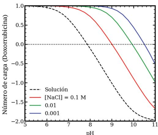
Figura 2.7: Gráfico que muestra el número de carga de la doxorrubicina dentro de la red de PMAA en función del pH, para diferentes concentraciones de sal (líneas sólidas), así como la carga promedio de la molécula en la solución bulk (línea discontinua);  $[Doxo] = 1 \text{ mM}$ .
