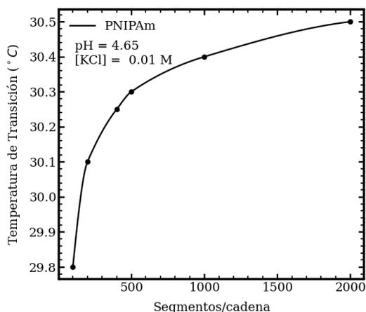
Figura 3.11: Gráfico de la variación de la temperatura de transición como función de los segmentos por cadena que componen la red polimérica. El polímero que compone el microgel está compuesto puramente por NIPAm. La concentración de sal es de 0.01 M y el pH de 4.65. La red polimérica está compuesta por  $N_{seg} = 10^7$  segmentos.
