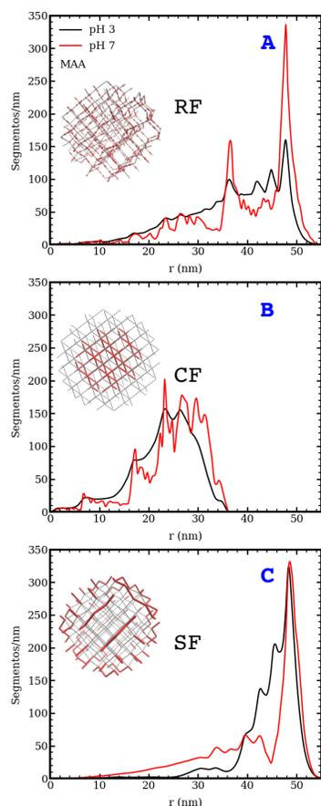
Figura 4.4: Distribución radial de segmentos MAA,  $\lambda_{MAA}(r)$ , a pH 3 y 7, y  $10^{-3}M$  NaCl; cada panel corresponde a un nanogel de MAA-VA diferente que tienen una funcionalización de red particular y 22% MAA. Estos grupos funcionales están completamente protonados (sin carga) a pH 3 y completamente disociados (cargados) a pH 7.
