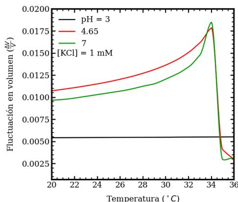
Figura 5.4: Gráfico de la fluctuación en volumen de un nanogel aislado. El nanogel está compuesto por  $5 \times 10^5$  segmentos (monómeros) repartidos en cadenas de 500 segmentos cada una.
