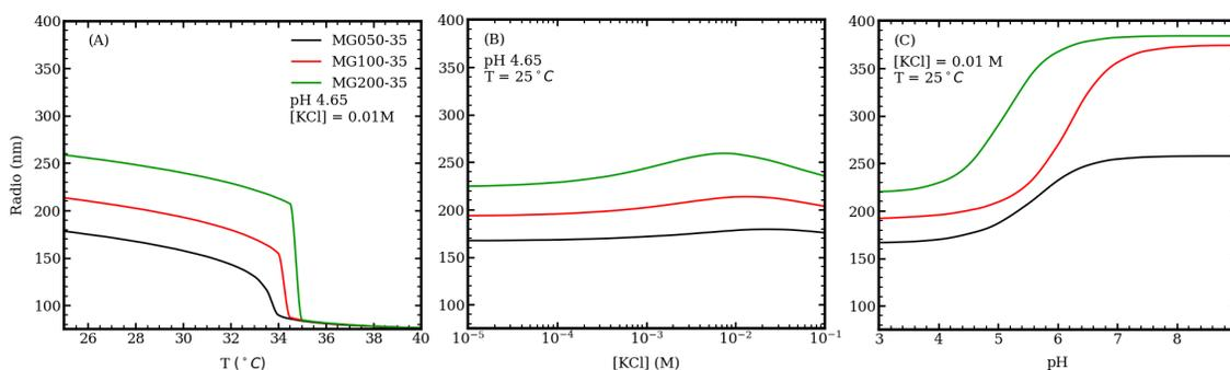
Figura 3.10: Gráfico del tamaño del microgel en función de la temperatura, la concentración de sal y el pH (paneles A, B y C respectivamente). Diferentes curvas corresponden a microgeles con segmentos de 50 (MG050), 100 (MG100) y 200 (MG200) por cadena de polímero, todos con 35 % MAA.
