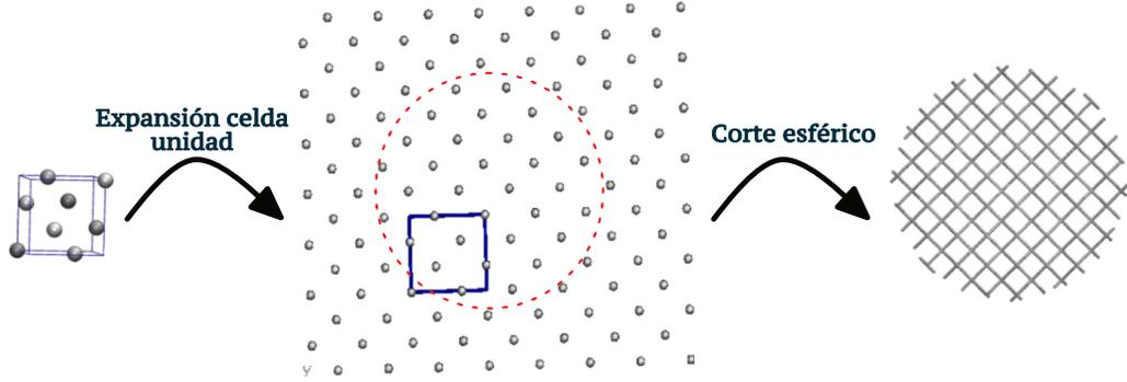
Figura A.1: Estructura base para la generación de configuraciones de nanogeles
