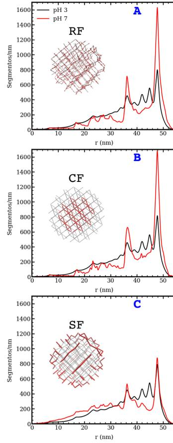
Figura 4.5: Distribución radial de todos los segmentos que componen la estructura del nanogel a pH 3 y 7, y  $10^{-3} M$  NaCl; cada panel corresponde a una funcionalización diferente de la red polimérica. Los nanogeles están funcionalizados con MAA.
