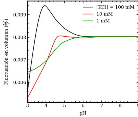
Figura 5.3: Gráfico de la fluctuación en volumen de un nanogel aislado. El nanogel está compuesto por  $5 \times 10^4$  segmentos (monómeros) repartidos en cadenas de 500 segmentos cada una
