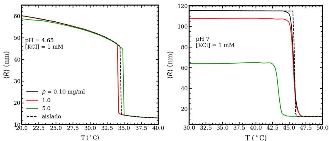
Figura 5.10: Radio medio de los nanogeles en solución como función de la temperatura de la solución. pH 4.65, [KCl] 1 mM. Curvas sólidas corresponden a concentraciones  $\rho = 0.10, 1.0$  y  $5.0$  mg/ml de nanogel, a trazos se presenta un sistema con una partícula polimérica aislada.
