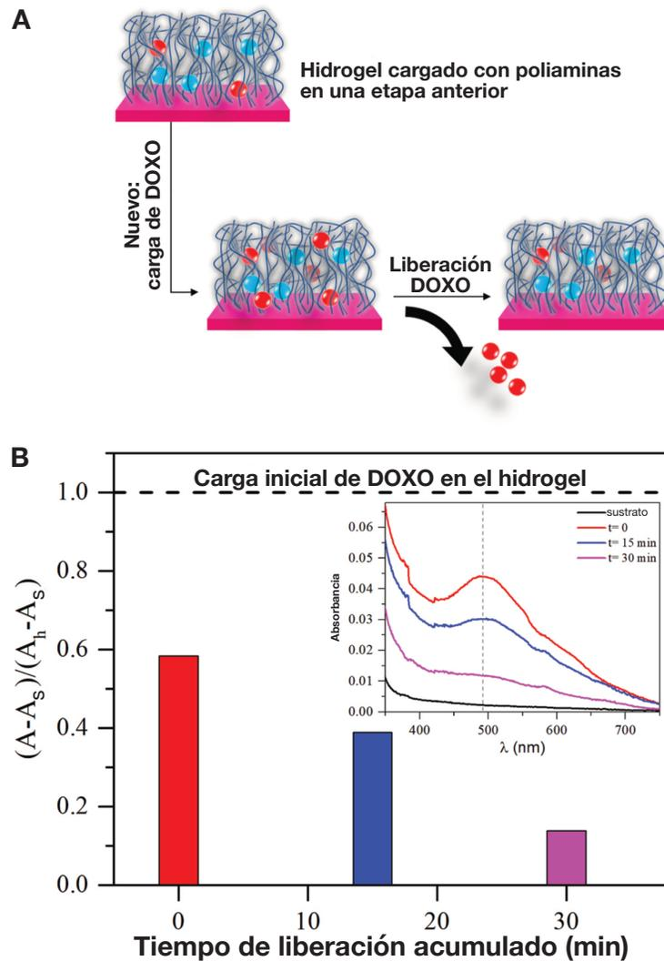
Figura 2.12: (A) Representación esquemática de la recarga/liberación de Doxo después de la adsorción de poliaminas. (B) El cambio en la absorbancia (a  $\lambda = 490$  nm) en relación con la carga inicial de Doxo en el film de hidrogel (línea discontinua).  $A_s$ : Absorbancia del sustrato de vidrio;  $A_h$ : Absorbancia de la carga inicial de Doxo en la película de hidrogel (antes de la adsorción de poliaminas: se muestra la espermidina).
