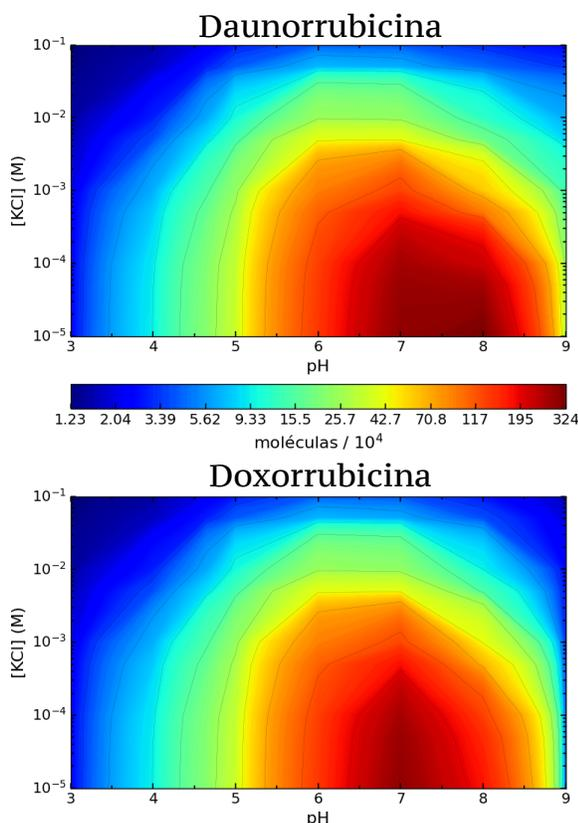
Figura 3.12: Mapas en color que muestran el número de moléculas de daunorrubicina (A) y doxorubicina (B) adsorbidas por microgel en función del pH de la solución y la concentración de sal. La concentración de fármaco en solución es  $1 \text{ mM}$  y  $T = 25^\circ\text{C}$ . el microgel de P(NIPAm-MAA) tiene  $n_{ch} = 100$  de longitud de cadena y 35% MAA (MG100-35).
