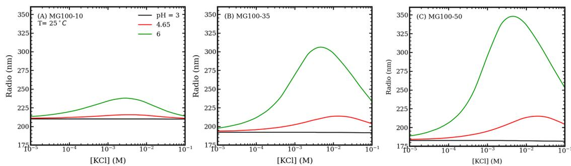
Figura 3.5: Gráfico del tamaño del microgel en función de la concentración de sal para diferentes soluciones de pH y  $T = 25^{\circ}C$ . Los paneles corresponden a microgeles MG-100 (longitud de cadena,  $n_{ch} = 100$ ) que tienen fracciones MAA: 10 % (A), 35 % (B) y 50 % (C).
