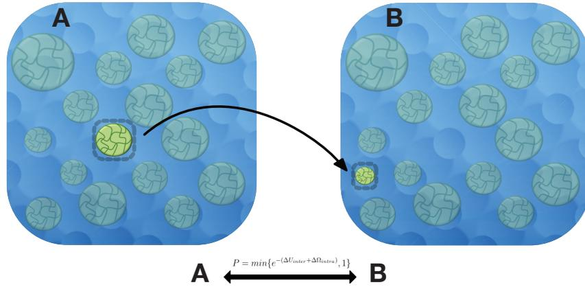
Figura 5.1: Esquema de un paso en el algoritmo de Metropolis-Monte Carlo. El paso de un estado **A** a uno **B** esta mediado por el cambio de energía entre ambas configuraciones.
