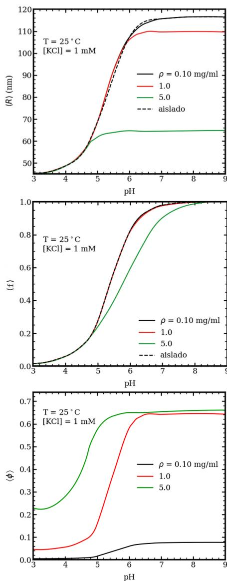
Figura 5.7: Variación de las propiedades medias de la solución de nanogeles en función del pH de trabajo. El panel A muestra el tamaño  $\langle R \rangle$ , el B el grado de carga  $\langle f \rangle$  y el C la fracción en volumen  $\langle \phi \rangle$ . La temperatura es de  $25^\circ\text{C}$  y la concentración salina de  $1\text{ mM}$  en  $[\text{KCl}]$ . Cada curva corresponde a un grado de empaquetamiento. Los nanogeles aislados se muestran en los paneles A, B y C.
