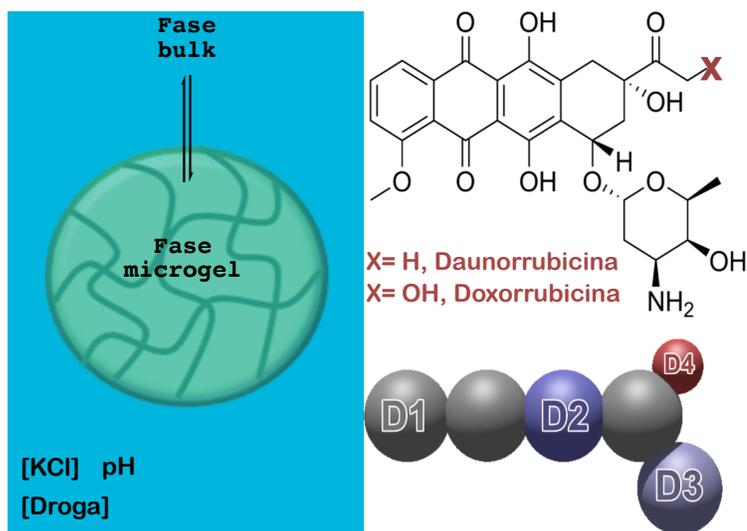
Figura 3.1: Microgel polimérico en solución. En el mismo se observan las dos fases que componen al sistema, la fase microgel y la fase solución. A la derecha se muestra la droga utilizada, así como el modelo usado para incorporar la información química que las definen.
