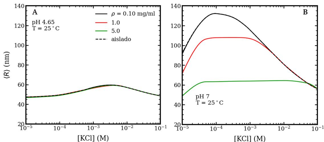
Figura 5.8: Variación del radio medio ( $\langle R \rangle$ ) con la concentración de sal para diferentes concentraciones de nanogeles. El pH es 4.65 y 7 para el panel A y B respectivamente. La temperatura del sistema es de 25°C. Las curvas sólidas corresponden a  $\rho = 0.10$ , 1.0 y 5.0 mg/ml de nanogeles, y a trazos se incorpora la respuesta de un nanogel aislado.
