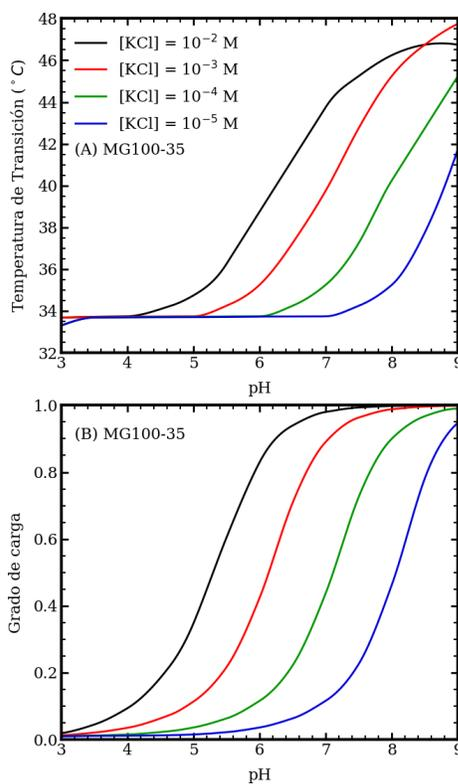
Figura 3.8: Gráficos que muestran la temperatura de transición de volumen  $T_{PT}$  (A) y la fracción de MAA cargado a esta temperatura (B) en función del pH para diferentes concentraciones de sal. Este microgel P(NIPAm-MAA) tiene una longitud de cadena de  $n_{ch} = 100$  y un 35% de MAA.
