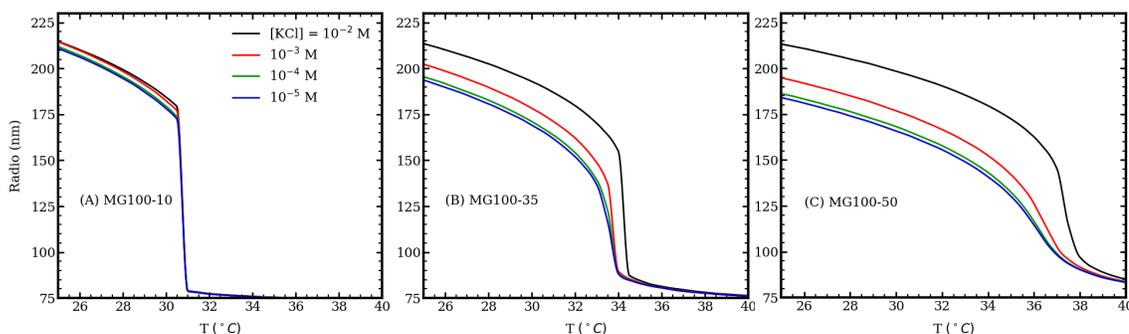
Figura 3.7: Gráfico del tamaño del microgel en función de la temperatura para diferentes concentraciones de sal en solución y pH 4.65. Los paneles corresponden a microgeles MG-100 (longitud de cadena,  $n_{ch} = 100$ ) que tienen diferentes fracciones de MAA: 10% (A), 35% (B) y 50% (C).
