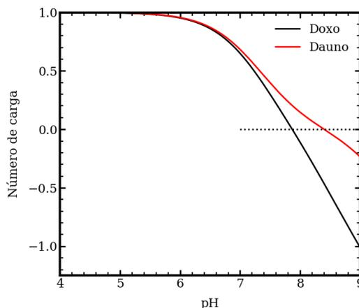
Figura 3.13: Número de carga de las drogas estudiadas: Doxorubicina y Daunorrubicina. La intersección con la línea punteada muestra el punto isoeléctrico de las mismas. Pasado este punto se da una inversión en la carga de las drogas lo que conlleva a una repulsión electrostática con los segmentos de MAA cargados del microgel.
