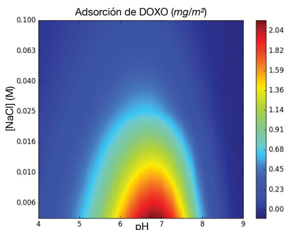
Figura 2.6: Mapa de color que muestra la adsorción de la doxorrubicina (ver ecuación 2.46) en función de la composición de la solución, es decir, el pH y  $[NaCl]$ ; la concentración del fármaco en la solución es  $[Doxo] = 1$  mM.
