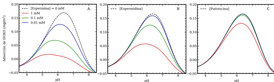
Figura 2.8: Gráfico de la adsorción de la doxorrubicina (ver ecuación 2.46) en función del pH para soluciones que contienen espermina (A), espermidina (B) y putrescina (C). En cada panel, las diversas curvas sólidas corresponden a soluciones con diferentes concentraciones de poliamina, mientras que la curva discontinua corresponde a una solución sin poliaminas. Todos los resultados corresponden a soluciones de 1 mM de Doxo y 100 mM de  $NaCl$ .
