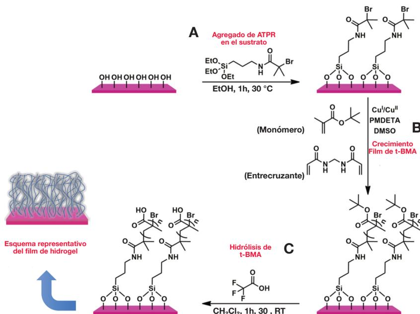
Figura 2.3: Pasos de la síntesis de la película delgada de PMAA, representados como: A) Iniciador ATRP en sustratos; B) Crecimiento de la película de t-BMA; C) Hidrólisis del t-BMA.
