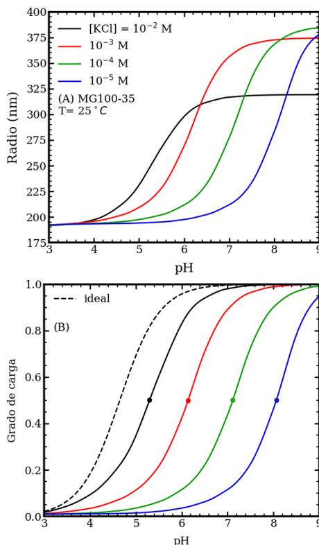
Figura 3.4: Tamaño de microgel (A) y grado de carga (B) en función del pH para soluciones que tienen diferentes concentraciones de sal y  $T = 25^\circ\text{C}$ . Las cadenas de polímero en el microgel MG100-35 tiene  $n_{ch} = 100$  segmentos de largo y 35% MAA. La curva punteada en el panel B es la disociación ideal del ácido metacrílico ( $pK_a = 4.65$ ). Los círculos de color en las curvas del panel A marcan el pKa aparente del microgel.
