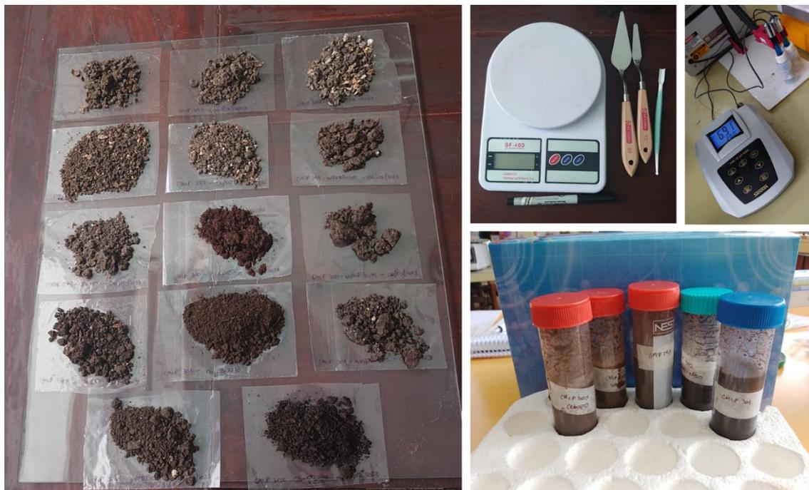
Imagen 27 – Preparación de las muestras de sedimento, utensilios para llevarlo a cabo y el equipo para evaluar el pH.
