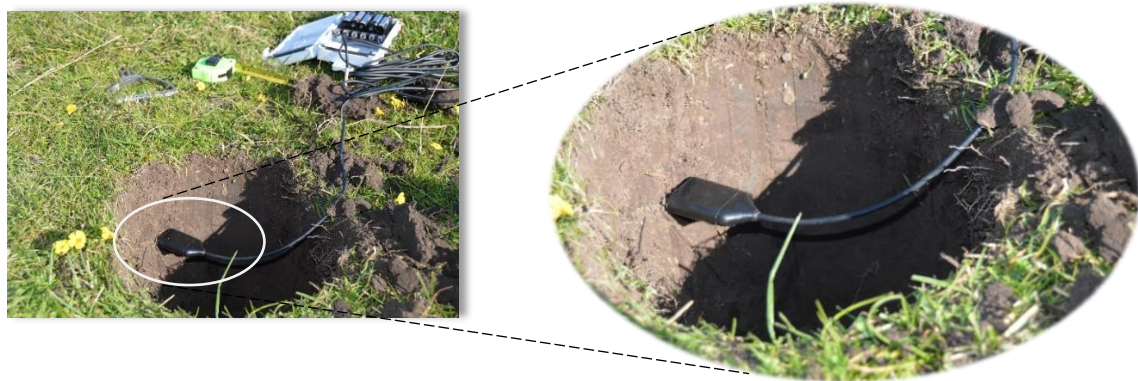
Figura II.5 Medición de la humedad superficial del suelo con el sensor ECH20-EC5 de Decagon.
