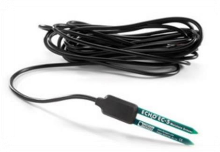
Figura II.4 Sensor móvil de capacitancia ECH2O-EC5 utilizado para medir el contenido volumétrico de agua en el suelo.
