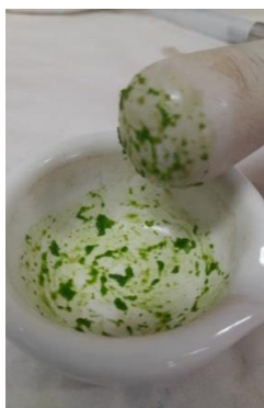
Figura 13: Mortero con homogeneizado de una muestra de hoja de pimiento. Imagen propia.
