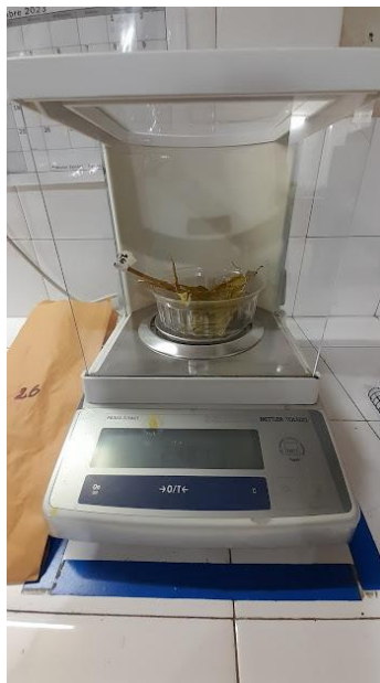
Figura 11: Balanza de precisión para la determinación del peso seco. Imagen propia.
