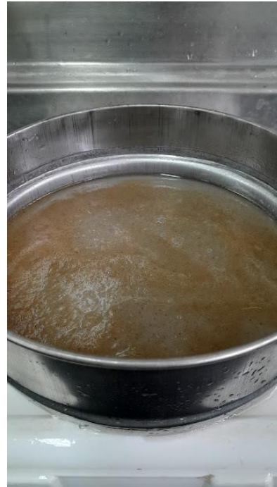
Figura 10: Tamiz con apertura de malla de 37µm con raíces procesadas. Imagen propia.
