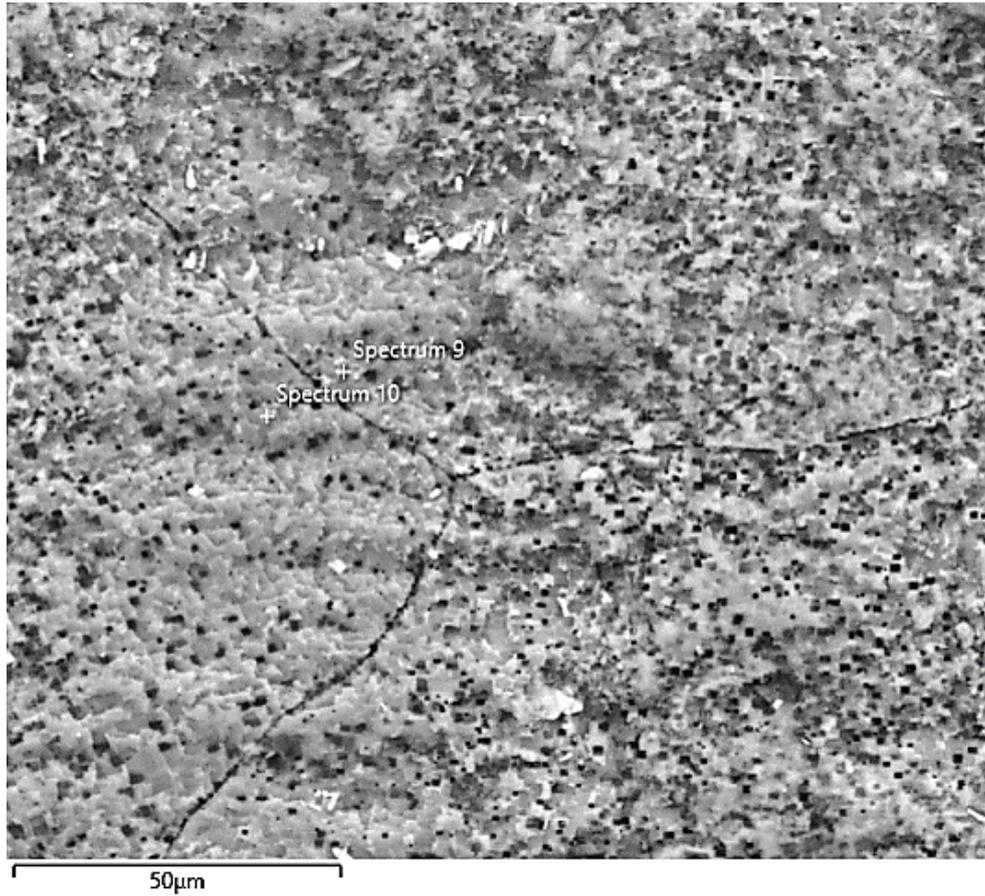
**Fig. 6.10.** Imagen MEB de la aleación de aluminio de alta pureza.
