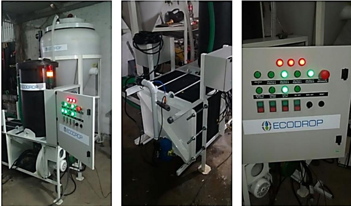
*Fig. 7.1. Equipos de electrocoagulación perteneciente a la empresa Ecodrop.*
