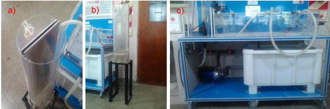
**Fig. 7.2.** Primer prototipo escalado de planta piloto para electrocoagulación. a) Disposición de los electrodos en el reactor. b) Reactor de electrocoagulación. c) Tanque superior para la decantación; tanque inferior para reservorio de efluente a tratar.
