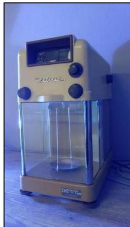
**Fig. 2.9.** Balanza analítica Mettler H5.
