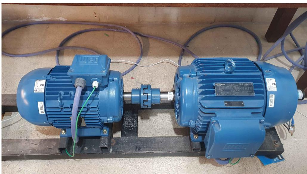
Figura 9: Máquinas acopladas mecánicamente. Izquierda, máquina de carga. Derecha, máquina de impulsión.
