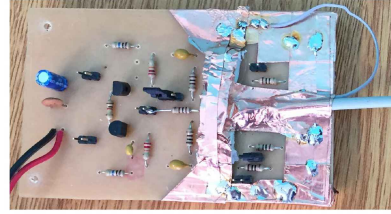
Figura 7. Placa construida físicamente. Se notan tanto los componentes soldados como el electrodo de guarda activa extendido con cinta de cobre para blindar electromagnéticamente las resistencias de polarización. La entrada del AO se encuentra conectada mediante un segmento de unos 10 cm de cable coaxial a un terminal BNC. La malla del cable se halla conectada a la guarda activa.
