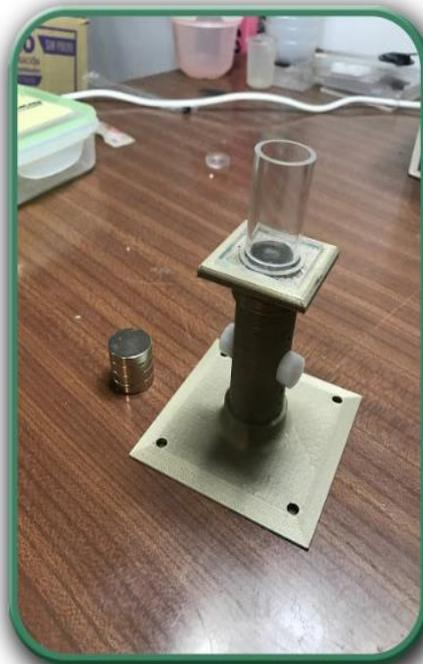
**Figura 2.9 Disposición experimental para mantener las proporciones del trabajo de Furlani y Ng (20). Se muestra el arreglo de imanes a la izquierda, el dispositivo fabricado en la impresora 3D y el recipiente de acrílico.**
