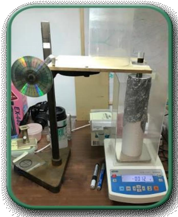
**Figura 3.24. Sistema gravimétrico utilizado para comparar las fuerza magnética en z con los perfiles de intensidad.**
