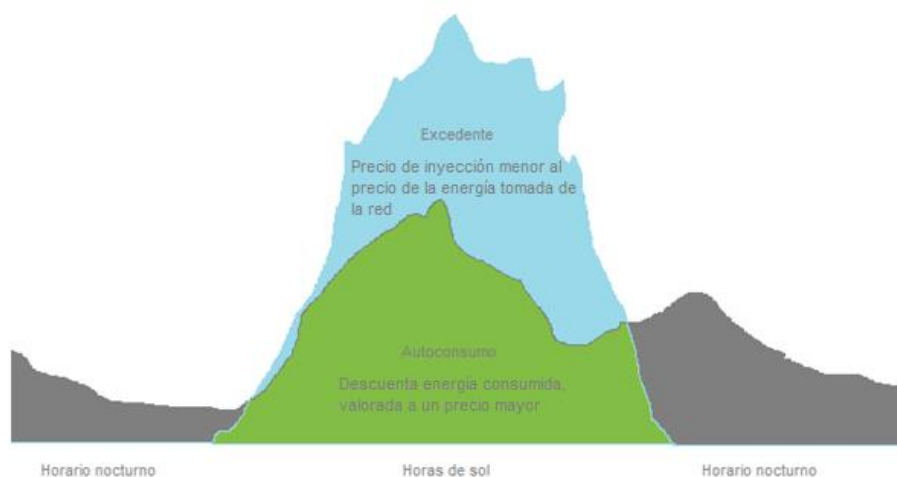
Figura 18: Representación generación fotovoltaica durante las horas de sol, parte de autoconsumo e inyección de excedentes. Elaboración propia.
