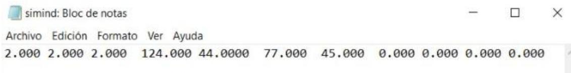
**Figura 3.6.** Archivo de extensión *.inp* con el que se simuló una lesión. Los primeros tres valores corresponden al volumen de esa lesión (expresado en voxels). Los valores 4, 5 y 6 indican la ubicación espacial. El séptimo valor es el de la concentración relativa (simil Zub) de RF en la lesión. Los valores restantes no son importantes para el trabajo.
