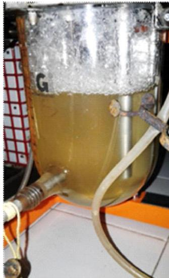
**Figura 2.2:** Formación de espuma durante un cultivo en biorreactor tipo tanque agitado
