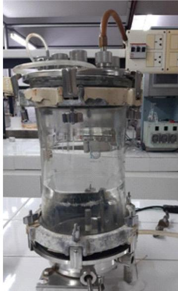
**Figura 2.3:** Biorreactor columna de burbujeo
