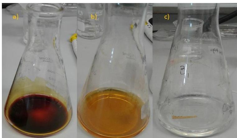
**Figura 1.3:** Titulación del  $\text{I}_2$ : a) inicio de la titulación b) cerca del punto final c) punto final de la titulación
