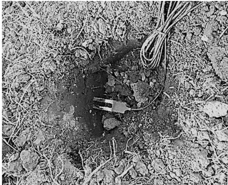
**Figura 3.5.** Detalle de la colocación del sensor de humedad en el suelo.
