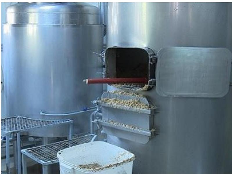
**Figura 5. Secado del BSG en horno (14).**
