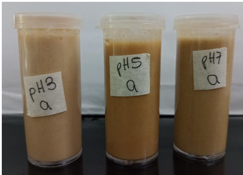
Figura 3.20. Emulsiones 30/70 (O/W) preparadas a partir de las dispersiones (al 8 %) a distintos pHs.
