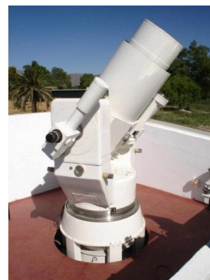
Figura 2: Telescopio SLR instalado en el Oafa
