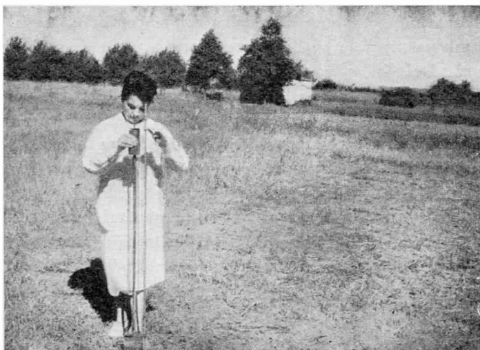
Fig. 4. — La pala dinamométrica adoptada, en funcionamiento, y vista panorámica del campo ensayado
