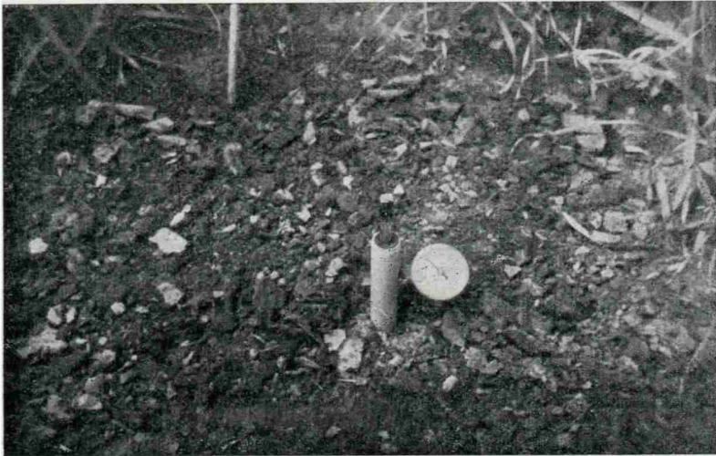
Fig. 4. — Tensiómetro c/vacuómetro a reloj Bourdon instalado a suelo desnudo en el seno de un cultivo de la Cátedra de Cerealicultura
