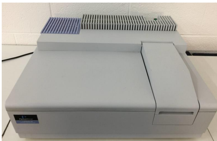
Figura 2. 5. Equipo espectrofotómetro Perkin Elmer LAMBDA 35 UV/Vis/NIR, utilizado para la caracterización por espectroscopía Uv-Vis.
