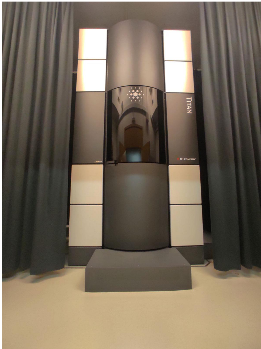
Figura 2. 1. Equipo Titan 80-300 “Cubo” corregido en el lente objetivo, utilizado para la caracterización por HRTEM.
