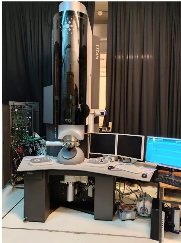
Figura 2. 2. Equipo Titan 60-300 Analítico corregido en el lente condensadora, utilizado para la caracterización por HRTEM/EDS/EELS.
