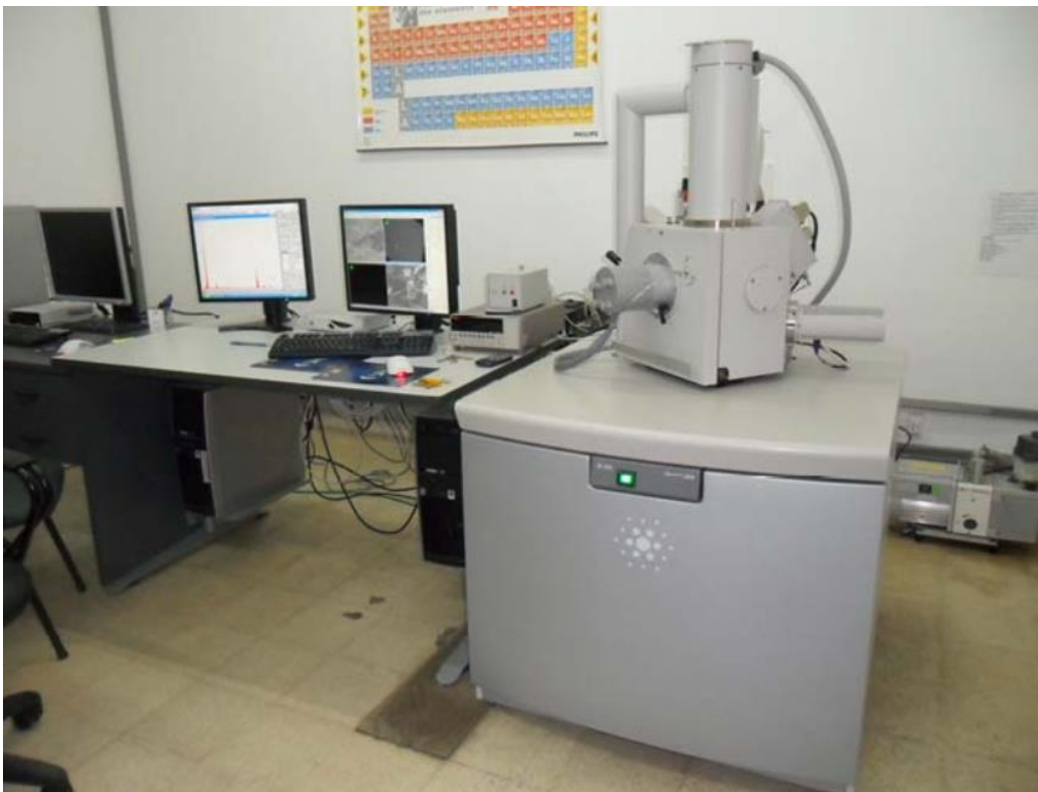
Figura 2. 3. Equipo FEI Quanta 200, utilizado para la caracterización por SEM de espumas de grafeno/níquel.
