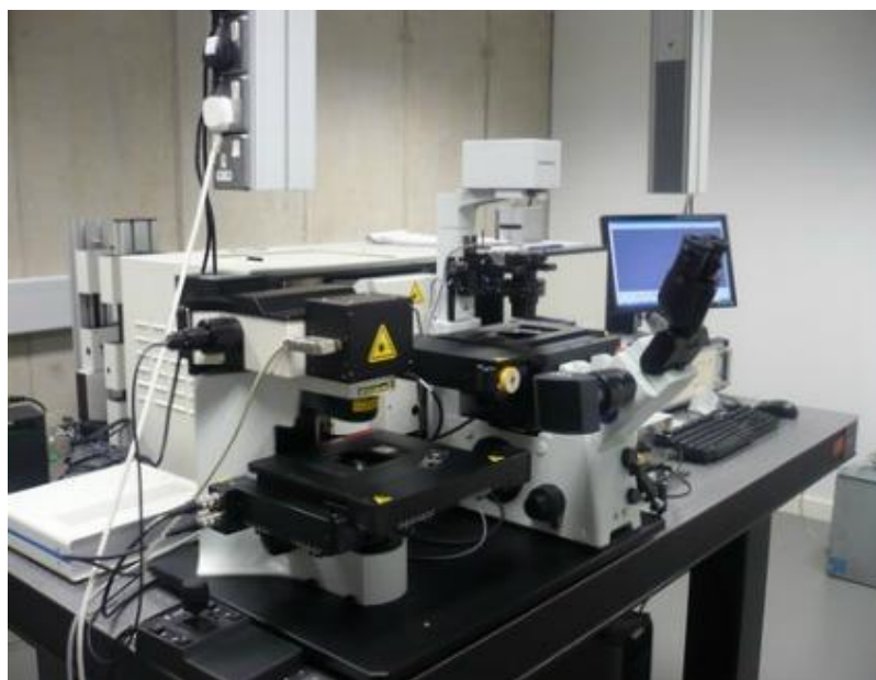
Figura 2. 8. Equipo Raman Horiba Jobin–Yvon LABRAM HR800, utilizado para la caracterización por espectroscopía Raman.
