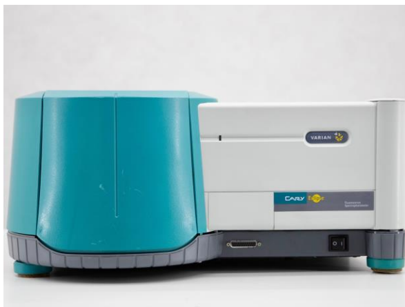
Figura 2. 6. Equipo espectrofotómetro Varian Cary-Eclipse, utilizado para la caracterización por espectroscopía de emisión de fluorescencia.
