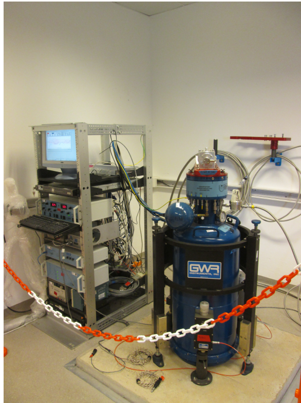
Figura 3.1. Gravímetro superconductor SG038 instalado en el laboratorio de gravimetría de AGGO.
