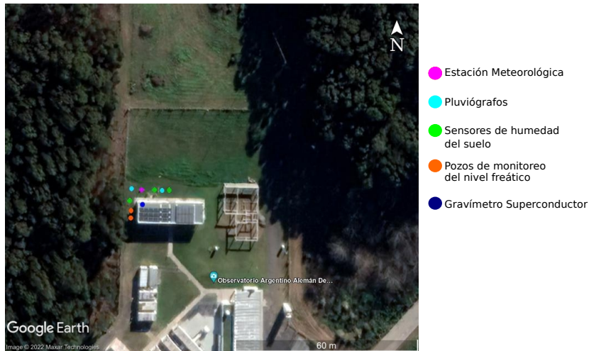
Figura 1.6. Ubicaciones del instrumental hidrometeorológico instalado en las cercanías del gravímetro superconductor.
