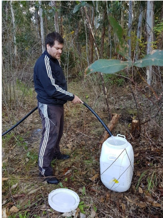
Figura 2.13. Medición manual del caudal bombeado utilizando un recipiente plástico de 65 litros.
