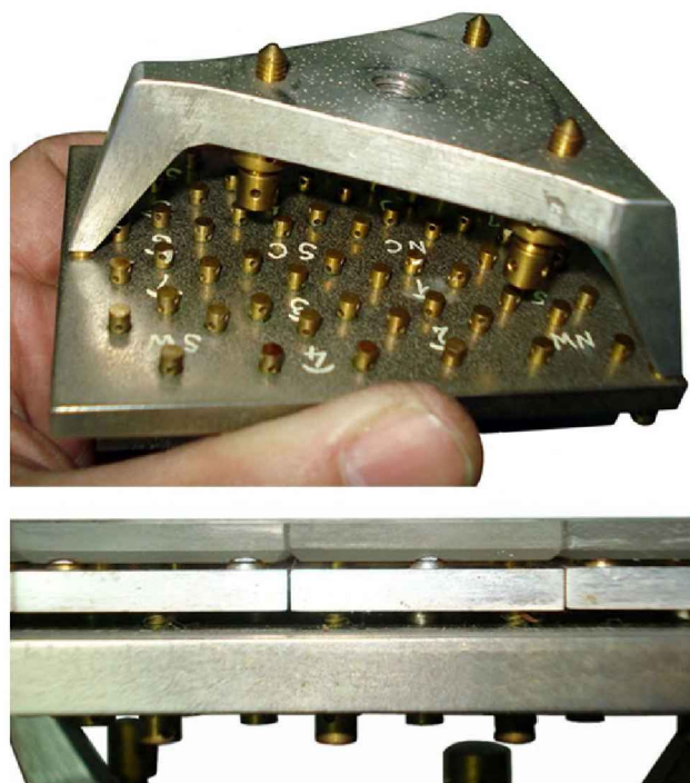
Fig. 4. Detalles del montaje de los espejitos y del sistema de tornillos de ajustes. Imagen superior: se aprecian diversas marcas que permitían ubicar correctamente el dispositivo y facilitar la alineación de los espejos (Museo OAC).
