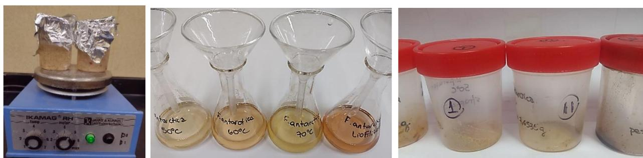
**Fig. 32** - Preparación de extractos: agitación (a), filtrado (b), liofilizado (C).
