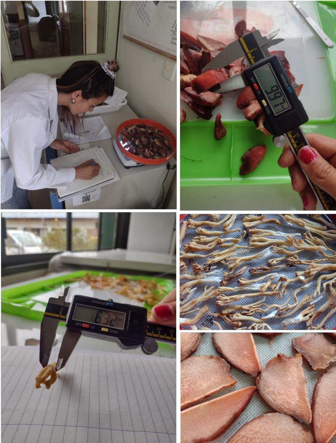
**Fig. 31** - Proceso de deshidratado. (A) Pesadas discontinuas; (B y C) Mediciones con calibre para el cálculo de % de reducción de volumen; (D y E) Porciones de los hongos en estudio (*R. patagonica* y *F. antarctica*, respectivamente) antes de someterlos al deshidratado.
