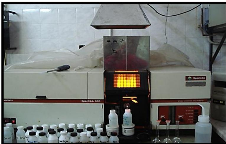
Figura 3.8: Instrumento de Absorción Atómica Varian SpectrAA 300.
