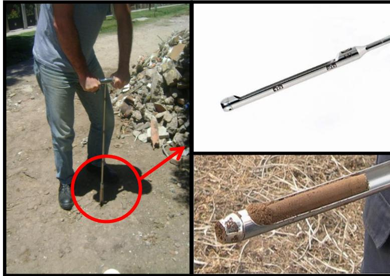
Figura 3.4: Toma de muestra de suelo (izq). Detalle de la parte inferior del barreno donde se puede observar las distintas profundidades y como sale la muestra.
