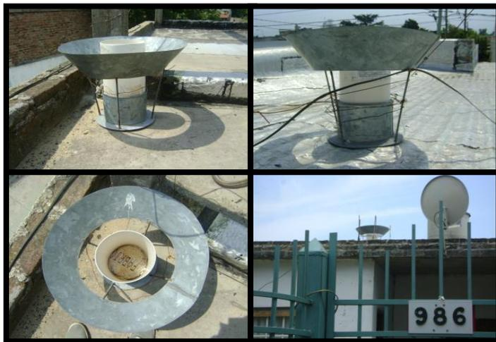
Figura 3.6: Toma de muestras de material particulado sedimentable.
