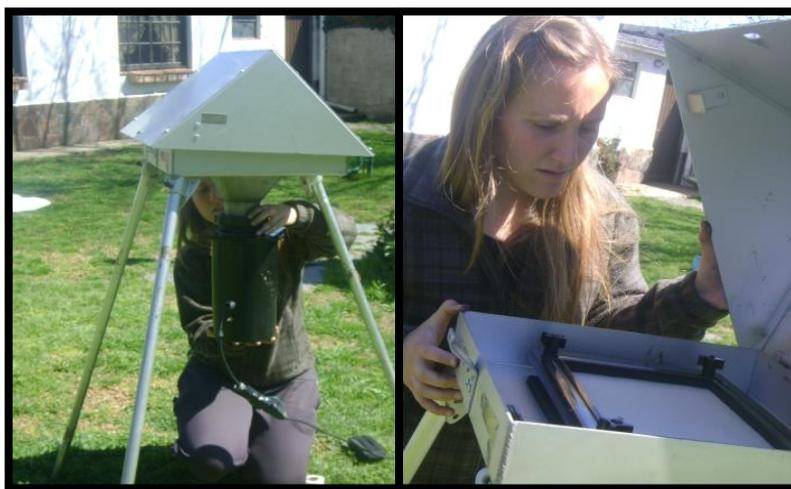
3.7: Muestreo de material particulado en suspensión con un equipo de Alto Volumen.
