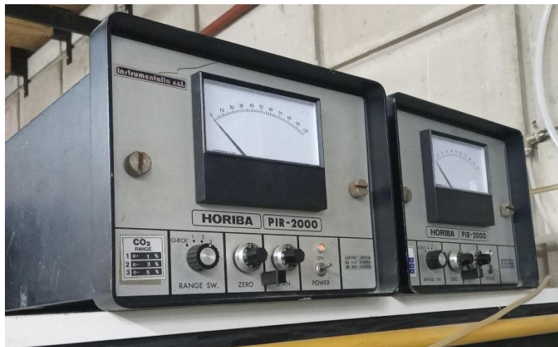
Figura 20: Detector infrarrojo de CO 2 Horiba® Pir 2000.
