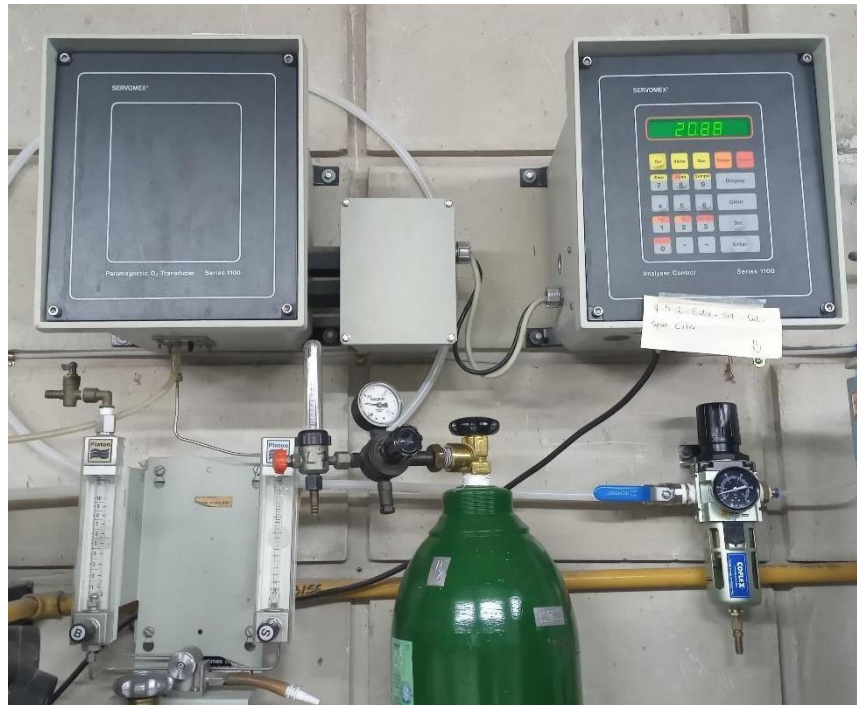
Figura 19: Detector paramagnético de O 2 Servomex® Series 1100.
