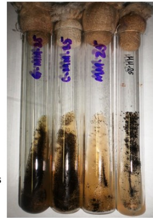
Figura 5. Porcentaje de cepas según su actividad deteriógena. La fotografía a la derecha muestra una prueba de actividad celulolítica con resultados positivos
