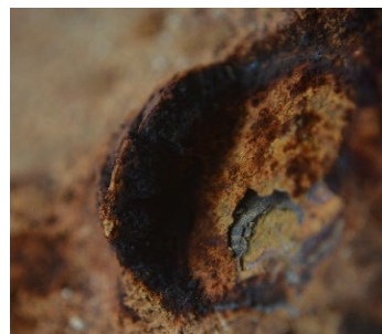
Figura 17 (a) Esquema de la corrosión localizada, extraída de Rosado, 2003 (b) Ampolla formada en los CAIs
