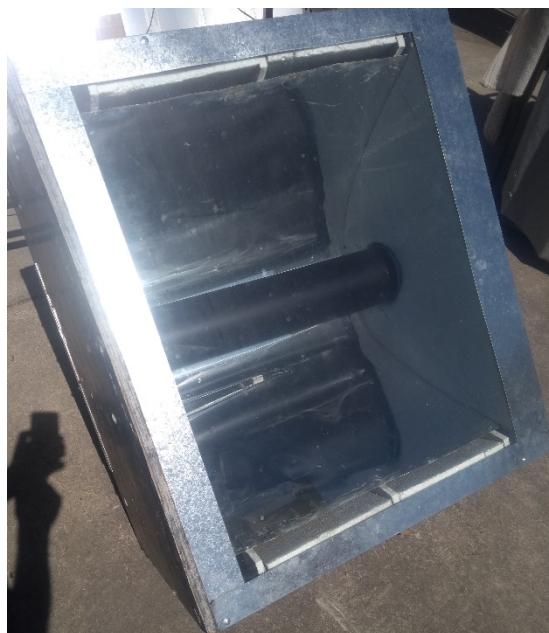
Figura 4. Foto del horno tubular CPC terminado.
