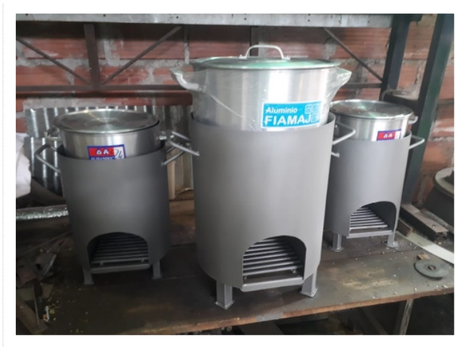
Figura N°1: Prototipos de cocinas a base de biomasa presentadas a la comunidad. Fuente: propia.
