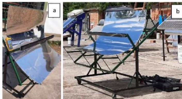
Figura 3. Concentrador cilindroparábólico construido y orientado hacia el sol.
