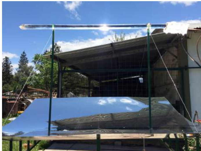
Figura 1: CCP tomado como caso de estudio para su simulación. Área de apertura solar: 5.41 \text{ m}^2 . Área de la cubierta de vidrio: 0,33 \text{ m}^2 . Área de absorbedor: 0,23 \text{ m}^2 .
