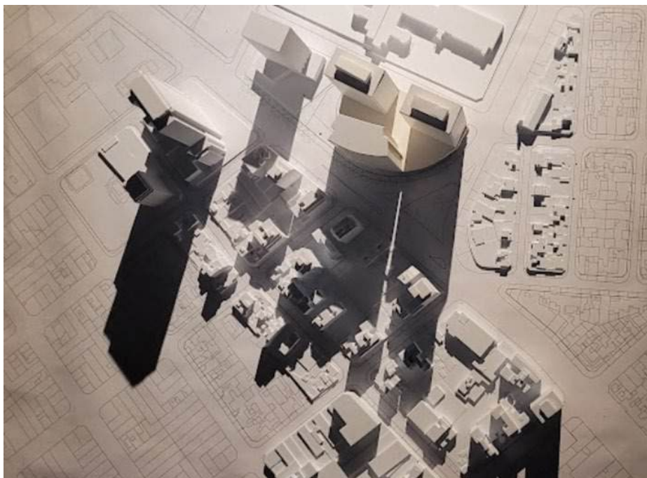
Figura 1. Maqueta física de la zona de influencia en el heliodon, escala 1:175.
