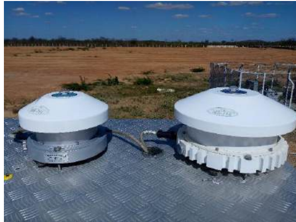
Figura 1: Espectroradiômetros EKO WISER nos modelos MS-711 (à esquerda) e MS-712 (à direita) da Plataforma Solar de Petrolina.
