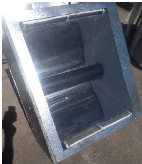
Figura 4. Foto del horno tubular CPC terminado.
