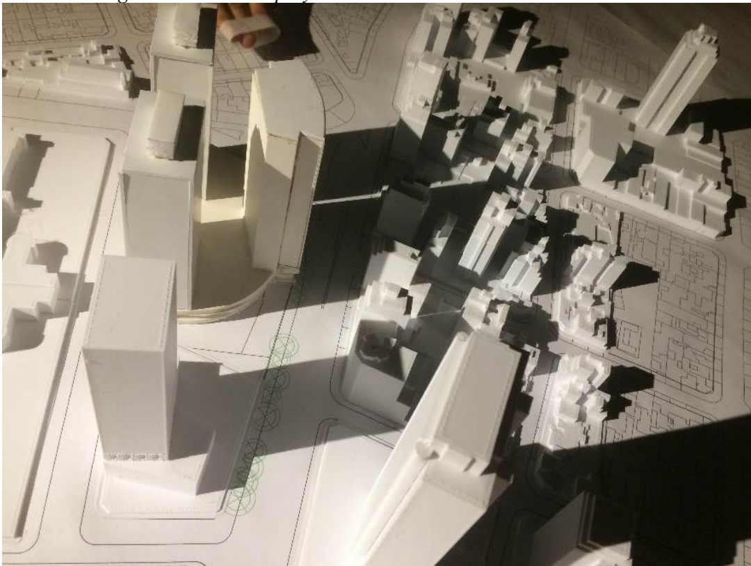
Figura 5: Vista de la maqueta física en el Heliodon, mediodía en invierno.
