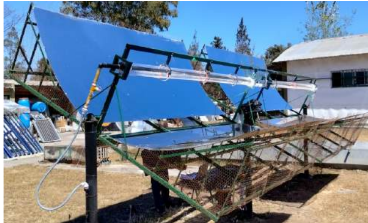
Figura 3: Equipo concentrador cilindroparabólico tomado como caso de estudio. Superficie reflectora de aluminio pulido espejo, absorbedor metálico y cubierta transparente de borosilicato.
