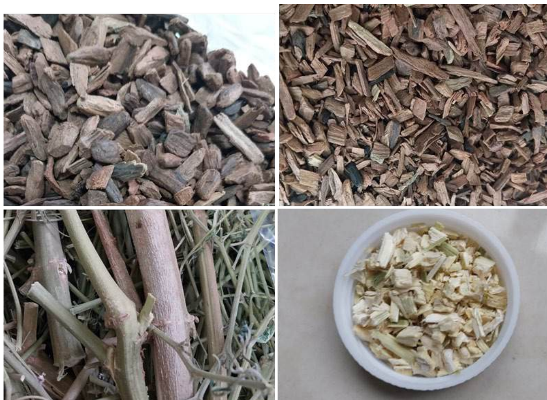
Figura 3: Biomosas antes y después del acondicionamiento. Arriba: AQ sin acondicionar (izquierda) y AQ acondicionado (derecha) Abajo: TC sin acondicionar (izquierda) y TC acondicionados (derecha)
