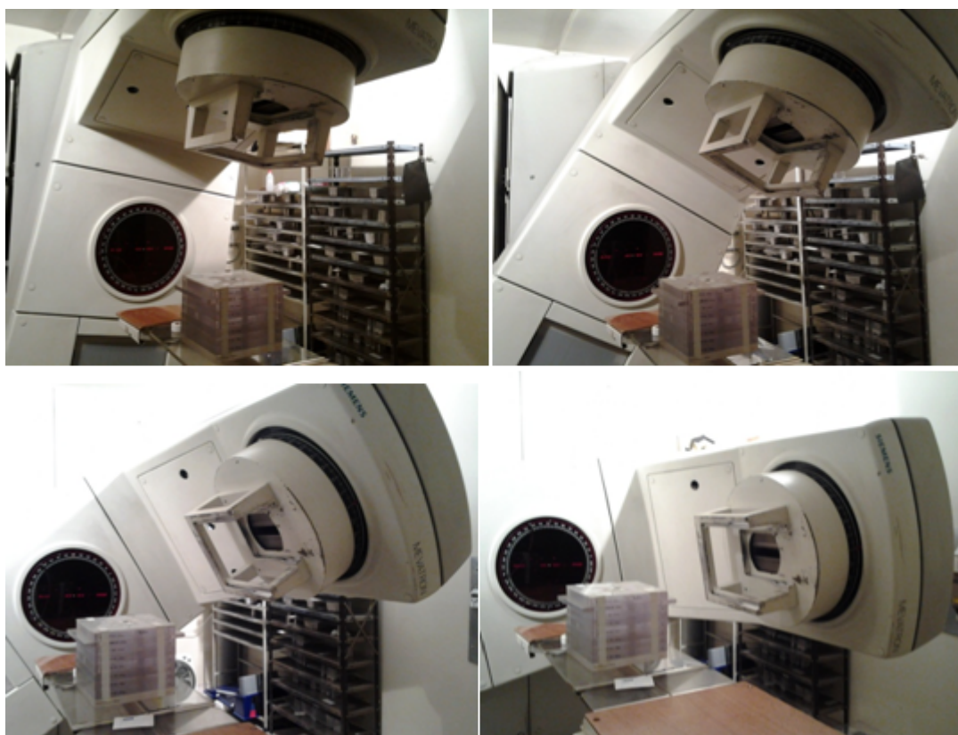
Figura 4.9: Irradiación de los OSLD para evaluar la dependencia con el ángulo de incidencia del haz de radiación.
