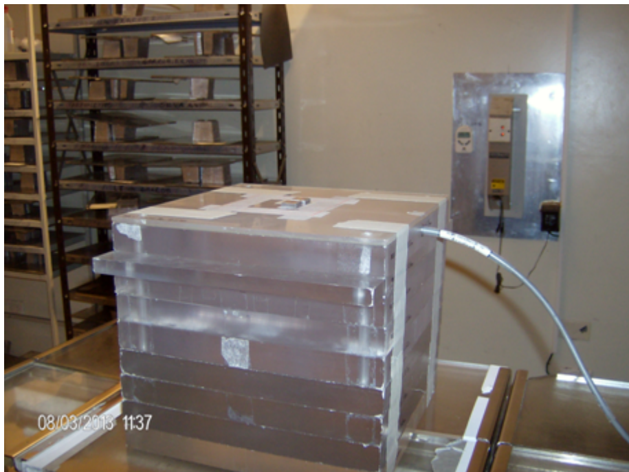
Figura 4.7: Irradiación de los OSLD y la cámara de ionización para evaluar la dependencia con la tasa de dosis.
