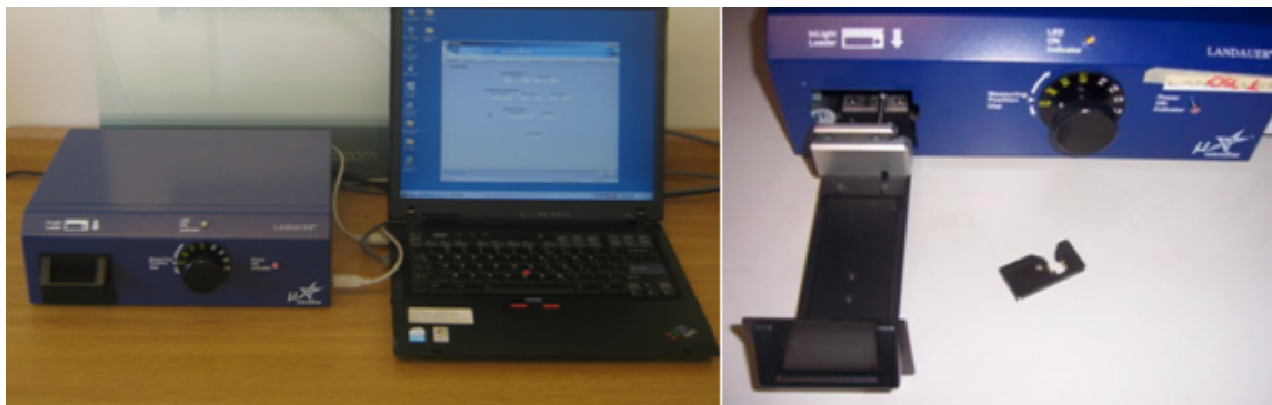
Figura 4.3: Sistema de lectura de los OSLD. Izquierda: lector microStar con el software correspondiente. Derecha: gaveta donde se coloca el OSLD para su lectura.
