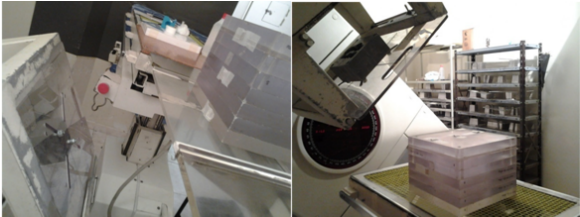
Figura 4.12: Verificación de la dosis en un punto en fantoma, con los filtros moduladores correspondientes.
