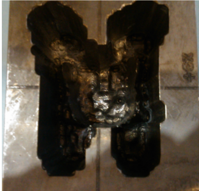
Figura 2.11: Foto de filtro compensador para un tratamiento de Cabeza y Cuello.
