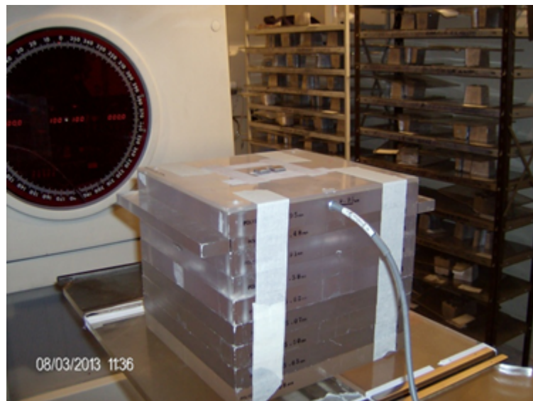
Figura 4.6: Irradiación de los OSLD y la cámara de ionización para obtener los factores de calibración.
