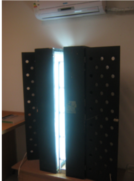
Figura 4.4: Sistema de blanqueo óptico de los OSLD.
