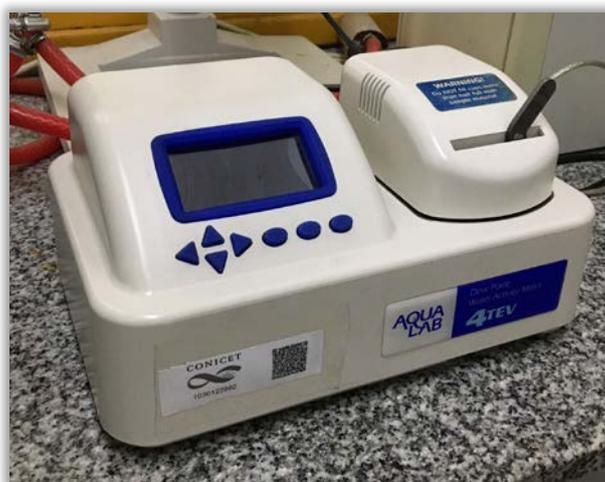
**Figura 4.1.** Equipo AquaLab Series 4 TEV usado para la medición de la actividad acuosa de las premezclas en polvo
