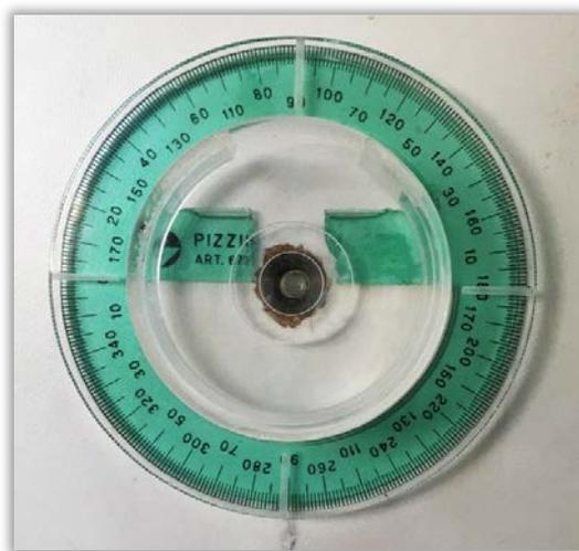
**Figura 4.2.** Dispositivo utilizado para la medición del ángulo de reposo en polvos
