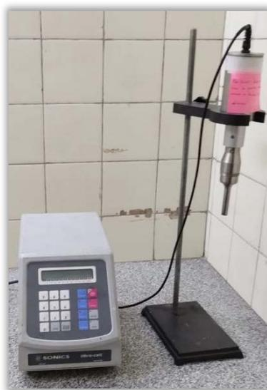
**Figura 2.2.** Homogeneizador ultrasónico VCX 750 (Sonics & Materials Inc., Newtown, EE. UU.)
