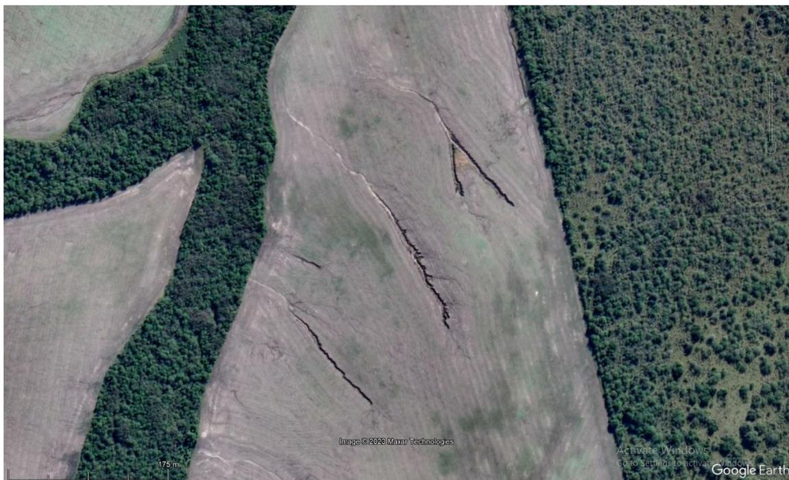
**Figura 91.** Cárcavas de erosión de hasta 5 m de ancho en campo.
