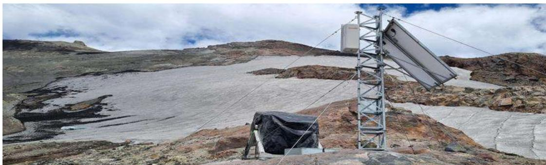
Figura 1: Detector de muones instalado en el flanco del volcán Copahue, provincia de Neuquén, Argentina.
