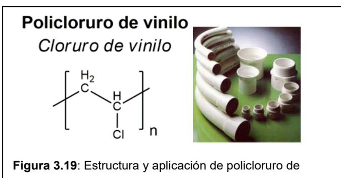
**Figura 3.19:** Estructura y aplicación de policloruro de
