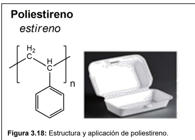
**Figura 3.18:** Estructura y aplicación de poliestireno.
