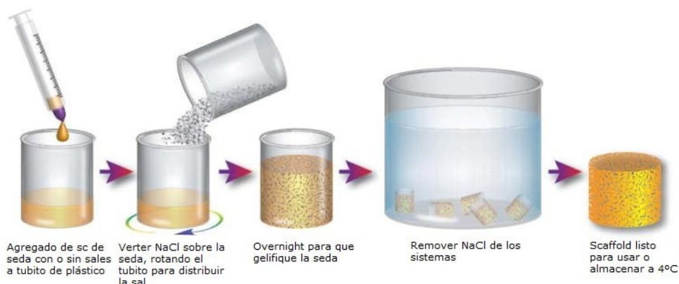
**Figura 2.** Proceso de síntesis de *scaffolds* porosos de seda por *salt-leaching* con NaCl. Adaptado de (Rockwood, 2011)
