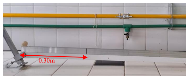
Figura 1. Plano inclinado de aluminio utilizado en el trabajo práctico. En rojo se muestra una de las marcas de distancias fijas en el plano.
