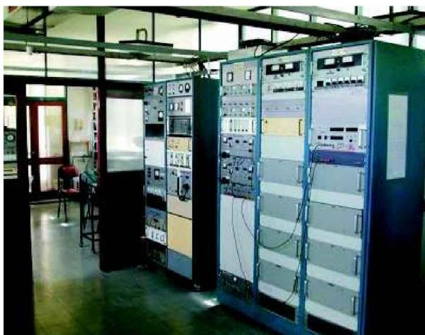
Figura 44 Autocorrelador Digital de 1008 canales.
