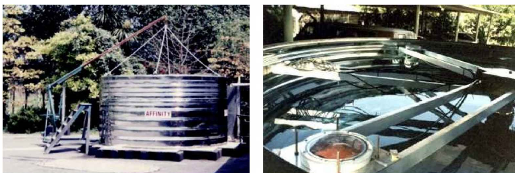
Figura 28 Tanque prototipo a escala completa desarrollado en el Laboratorio Tandar a partir de diciembre de 1995 (tomado de una presentación de Alberto Filevich). Izquierda: Vista exterior. Se aprecian la tapa removible y el piso suspendido para la ubicación de centelladores plásticos por debajo. Derecha: Vista del interior, con brazos para realizar cambios en la ubicación de los fotomultiplicadores.
