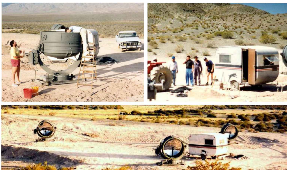
Figura 16 Primera etapa de instalación de GAMAR-1, diciembre de 1993. Arriba izquierda: José Luis Aballay (parado) y Adrián Rovero nivelando el espejo de uno de los searchlights. Arriba derecha: Escena de la “vida cotidiana” de esos días. De izquierda a derecha: Carlos Domínguez, José Luis Aballay, Rubén Domínguez y Eduardo Colombo. La casa rodante fue la primer sala de control. Abajo: Sistema instalado a fines de 1993.
