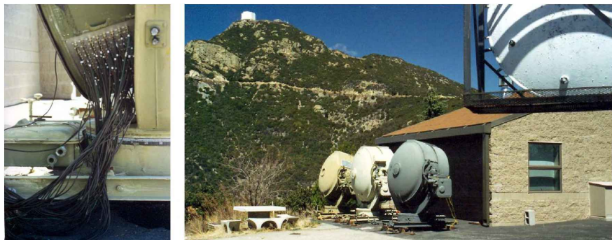
Figura 21 Prototipo para la segunda etapa, GAMAR-2, comenzada en el Observatorio Whipple, Arizona. Izquierda: Salida de los 64 canales de señal del fotomultiplicador multiánodo. Derecha: Los tres searchlights utilizados para el prototipo, al lado del cuarto de control del telescopio de 10 m. Se observa en el pico de la montaña al “Multi-mirror Telescope”.
