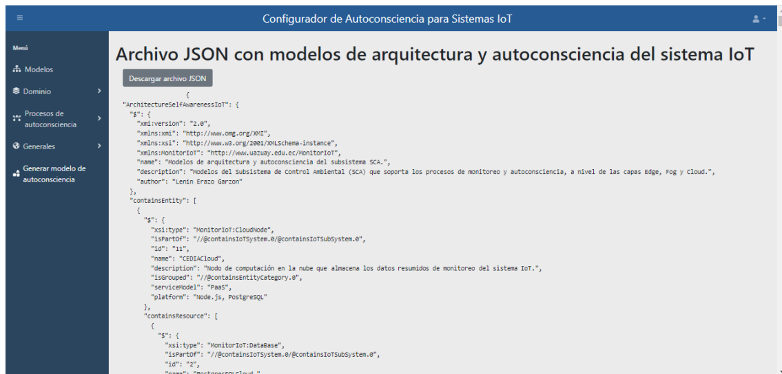
Figura 6-39. Generación del archivo JSON con las especificaciones de arquitectura y autoconciencia del subsistema SCA. Fuente: Elaboración propia.
