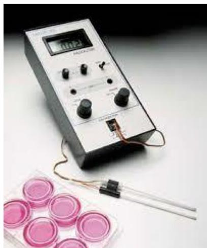
*Imagen 1.2.* Voltímetro Millicell®-ERS
