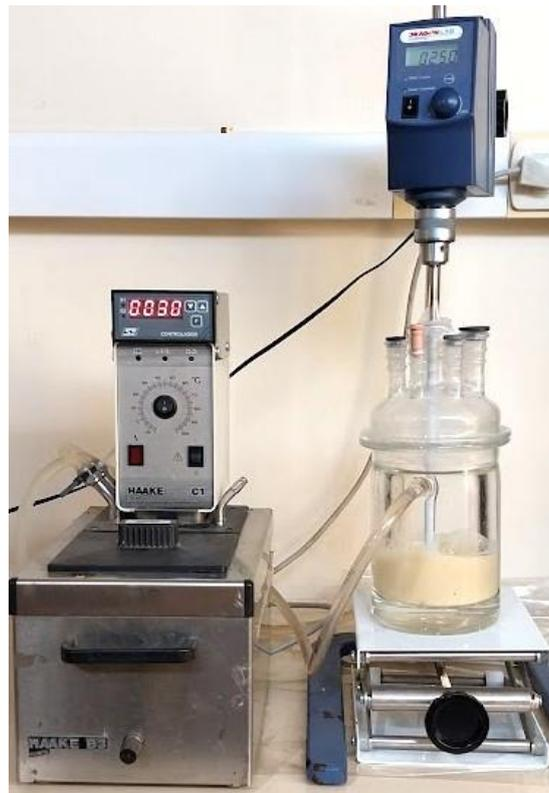
**Imagen II.1.** Bio-reactor utilizado en la fermentación natural de H
