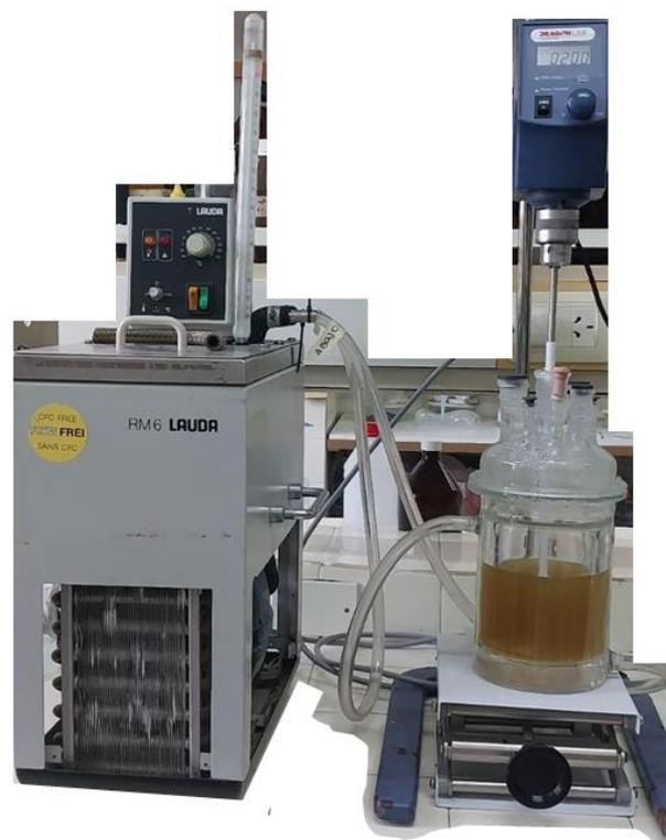
**Imagen 1.1.** Bio-reactor utilizado para el proceso de DGIS.
